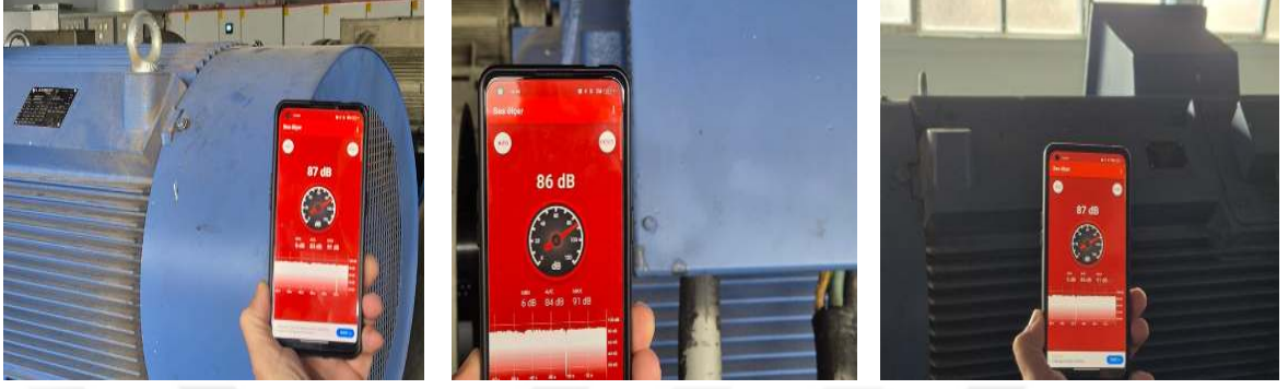
Şekil 3.14: İnvertörlü Motorun Gürültü Ölçümleri
