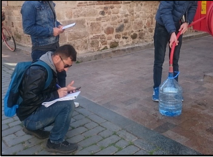
Şekil 4.3. Yangın musluklarının debisinin belirlenmesi
