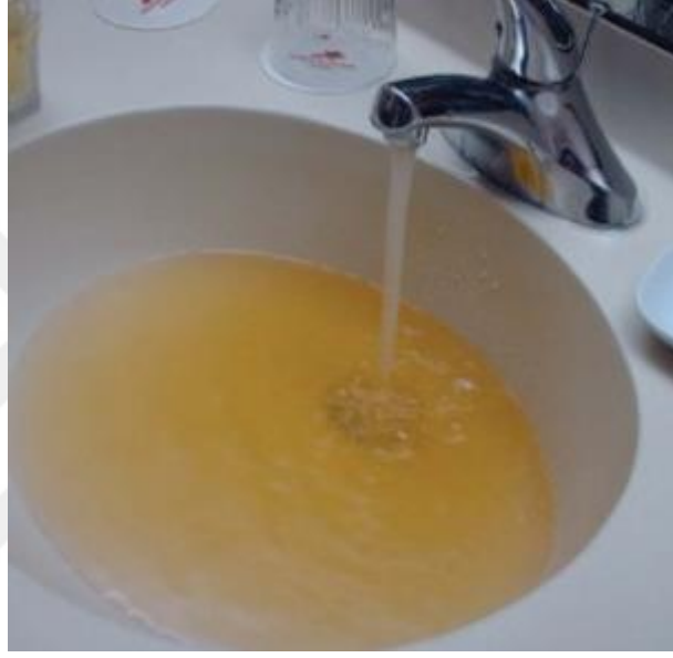
Şekil 4.21. Musluk suyunda demirden kaynaklı renk oluşumu.
