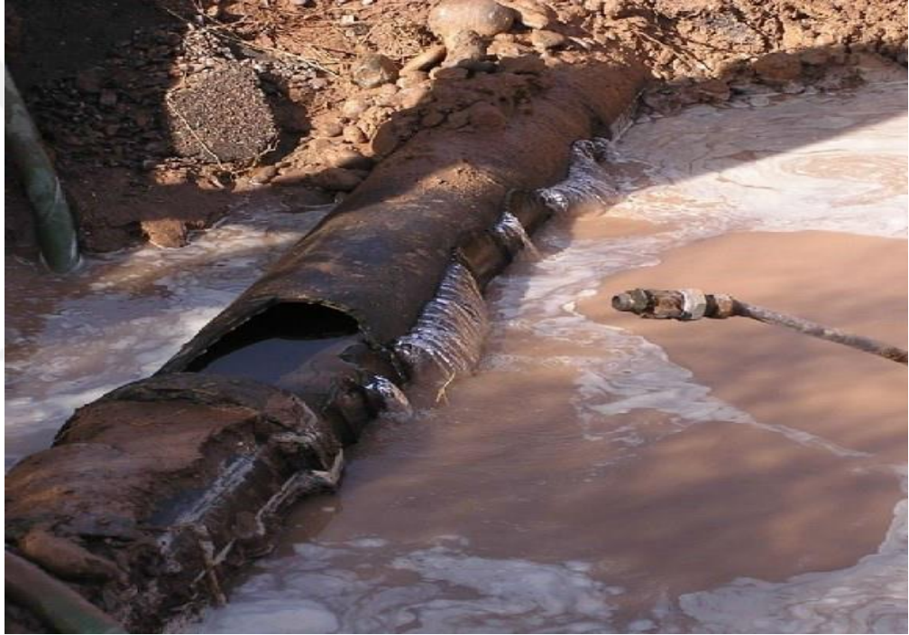
Şekil 2.6. Şebeke Yaşına Bağlı Olarak Çürüyen Boru
