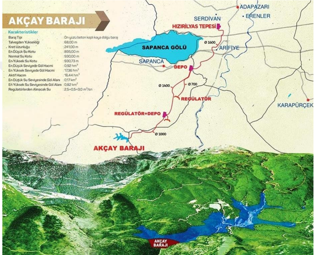
Şekil 2.3. Akçay Barajı bilgileri ve baraj suyu iletimi ağı yapısı.
