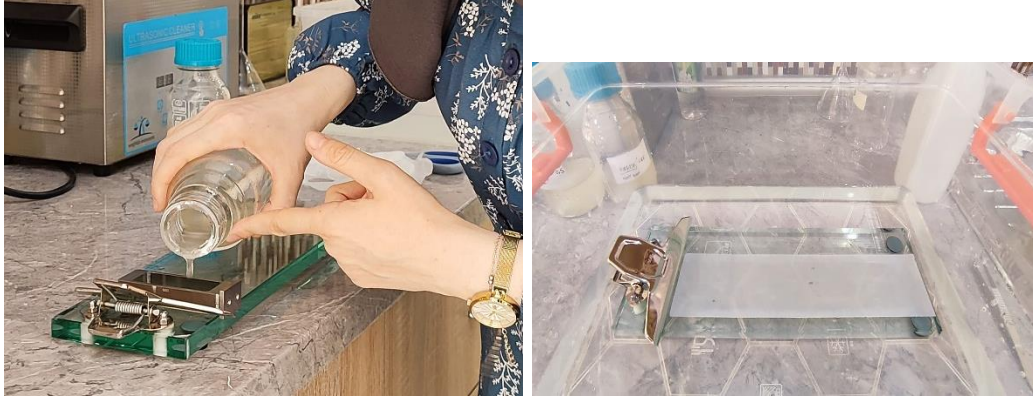
Şekil 3.4. a) Membran çözeltisi dökümü, b) Koagülasyon banyosu işlemi.
