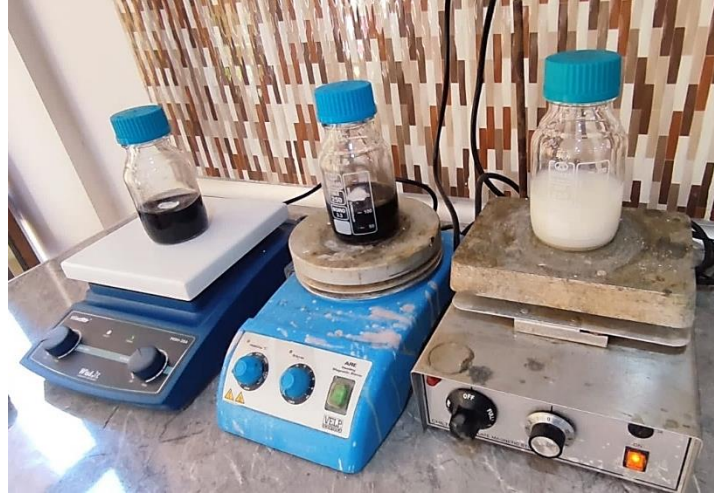
Şekil 3.2. Isıtıcıli manyetik karıştırıcı ve polimerli membran solüsyonları.
