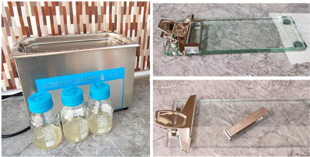
Şekil 3.3. a) Ultrasonic su banyosu, b) Membran döküm camı ve bıçağı.
