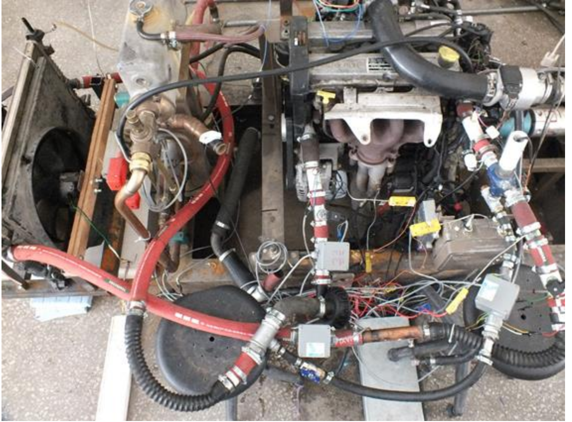
Şekil 4.48. Kontrollü soğutma sisteminin deney düzeneği (Durum 3)
