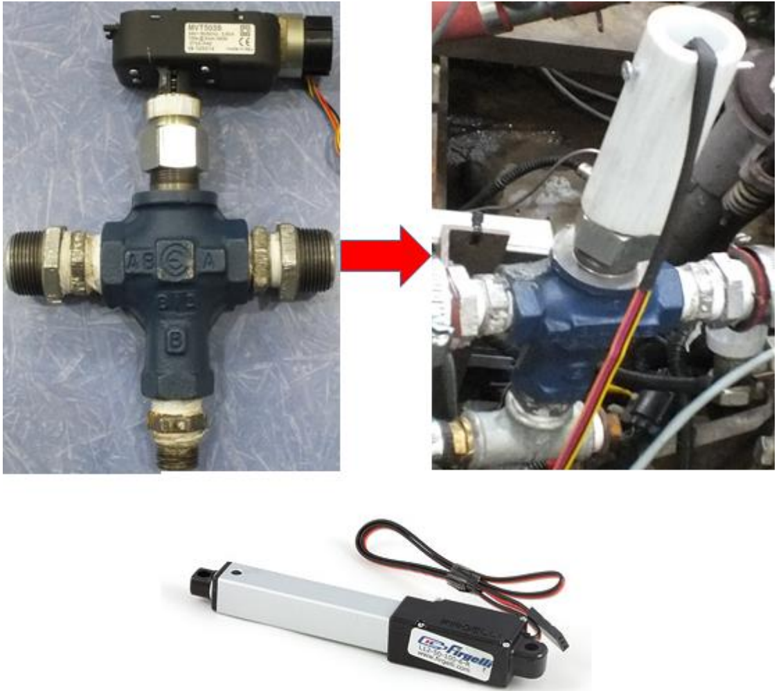
Şekil 4.49. Termostatın yerine kullanılan kontrollü valf ve değişiklikleri
