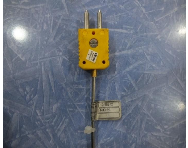
Şekil 3.13. Tez kapsamında kullanılan Termokupl
