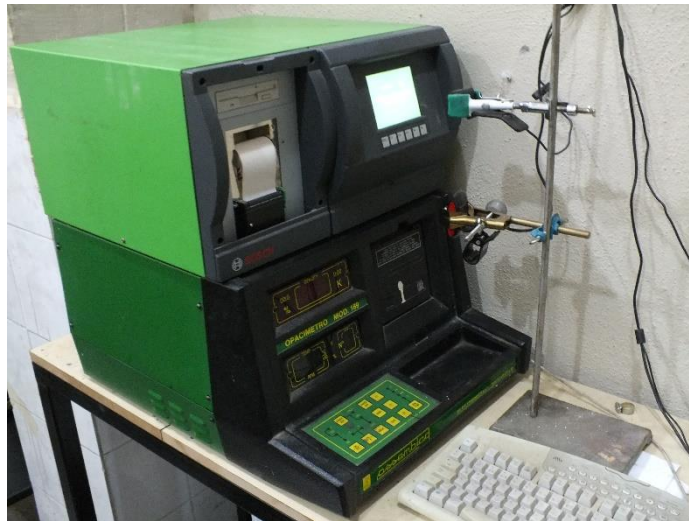
Şekil 3.16. Egzoz emisyonlarını ölçen cihaz
