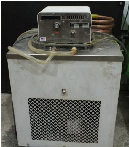
Şekil 3.12. Termokuplerin kalibrasyon cihazı
