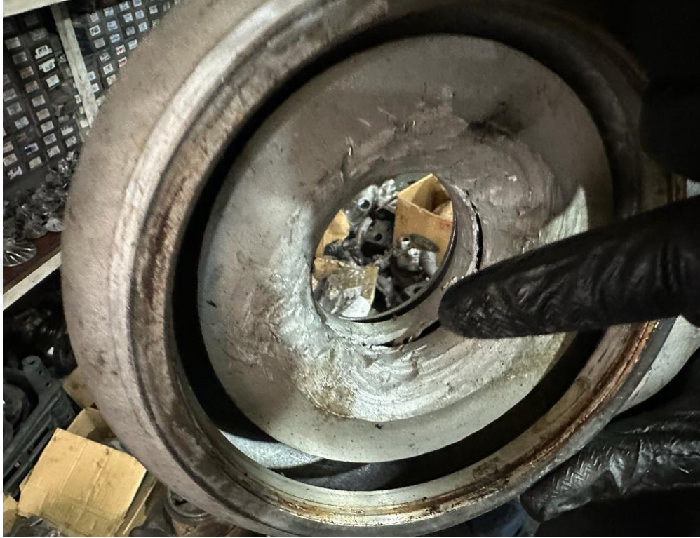
Şekil 3.4. Mekanik hasara uğramış bir turbo motor
