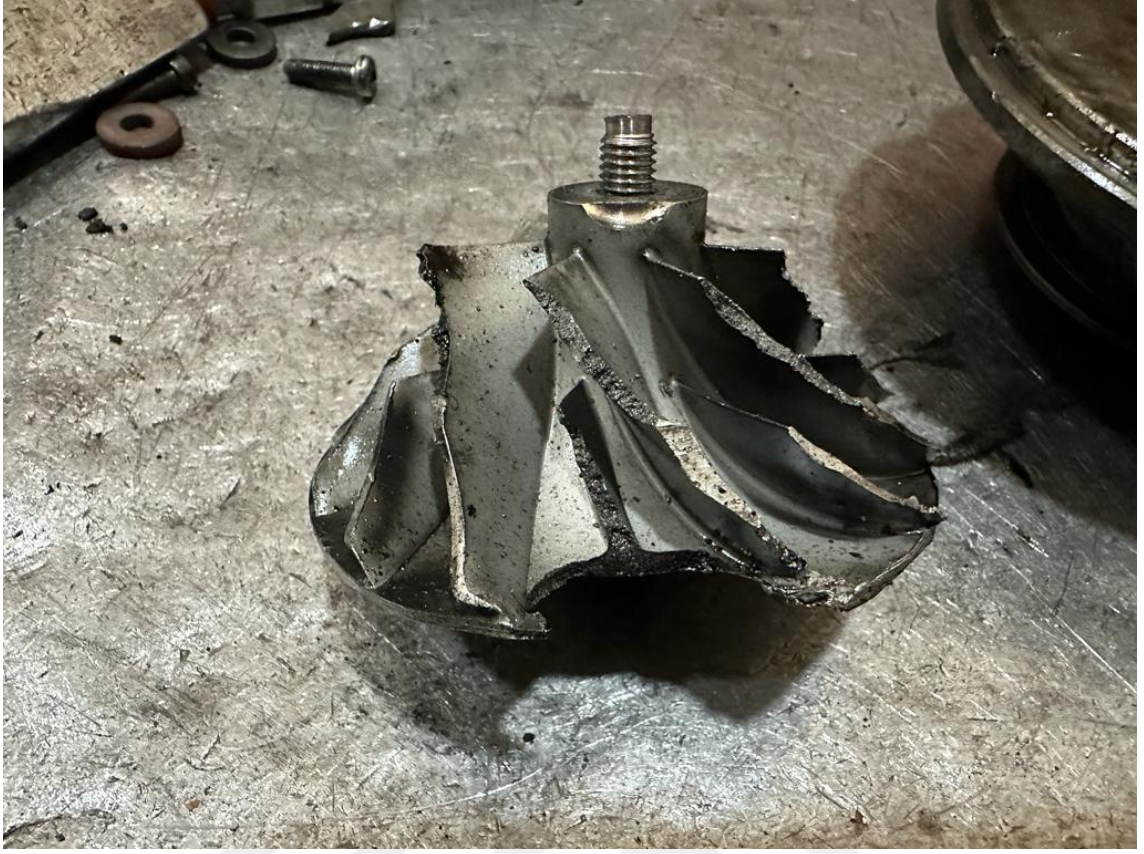
Şekil 3.7. İmal yöntemi esaslı hasar oluşumu
