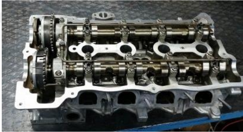
Şekil 1.4. Örnek bir silindir kapağı (Anonim)
