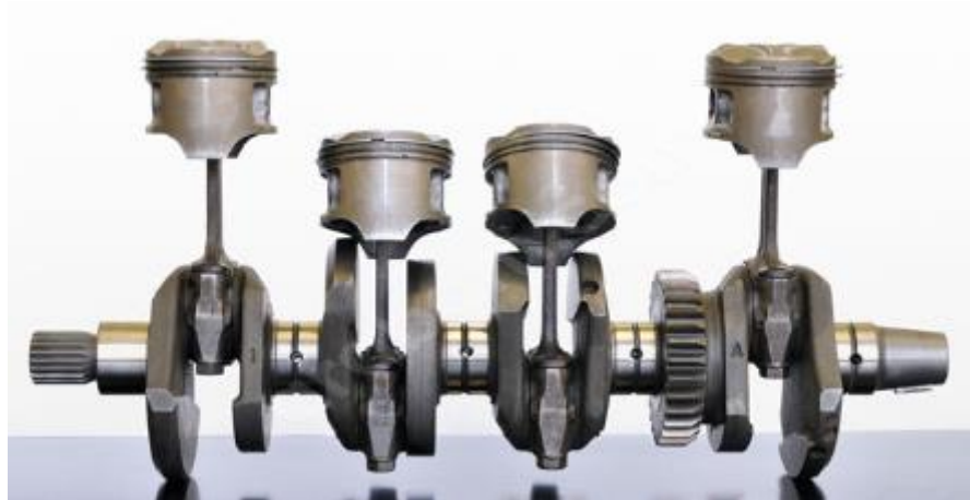
Şekil 1.13. Krank mili mekanizması (Anonim).
