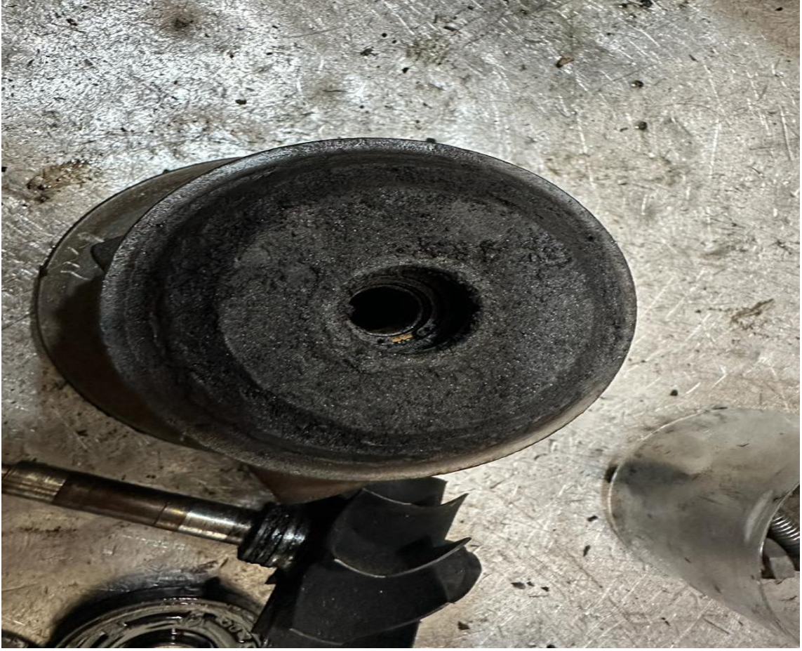
Şekil 3.9. Yanmış yağ kullanımı sonucu oluşan turbo hasarı
