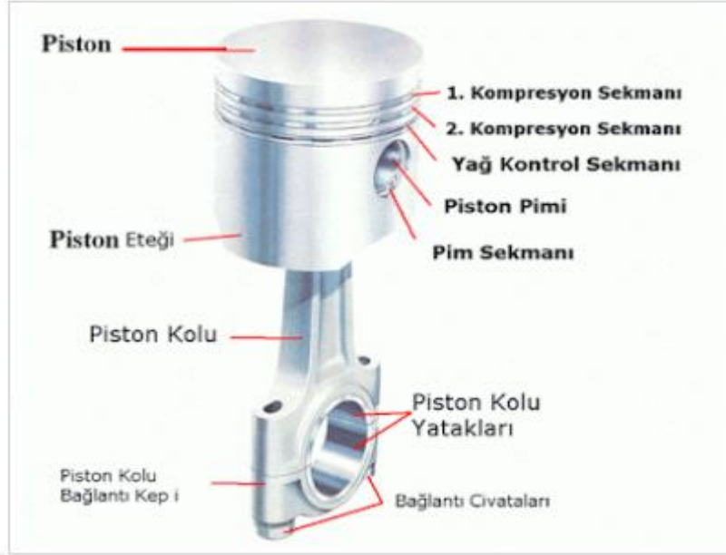
Şekil 1.12. Piston mekanizması (Anonim)
