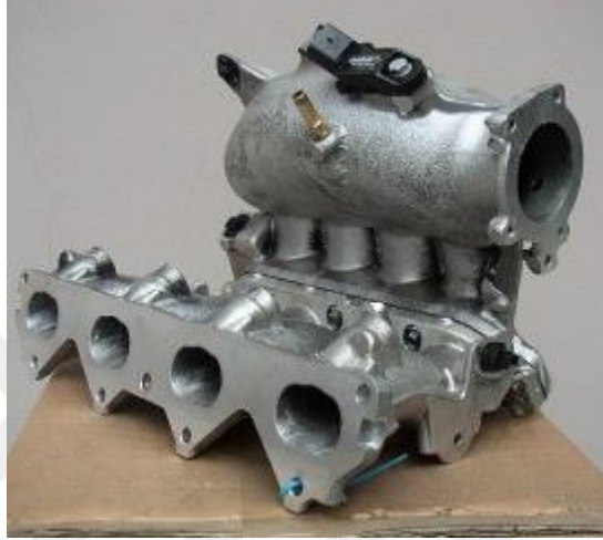
Şekil 1.5. Örnek bir emme manifoldu görseli (Anonim)
