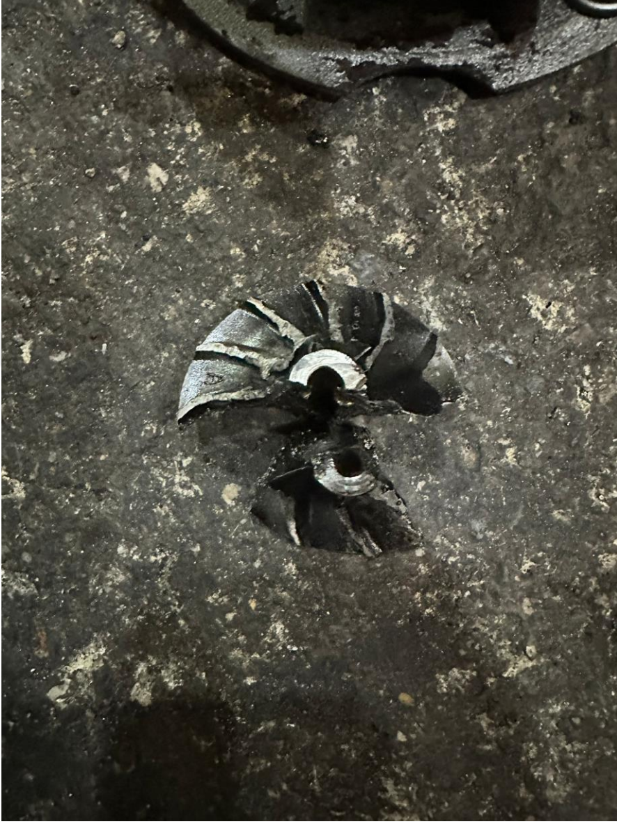
Şekil 3.13. Kırılan turbo kanatçığı
