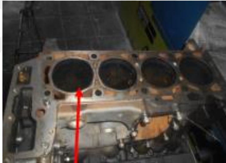
Şekil 3.12. Silindirde meydana gelen ovallik
