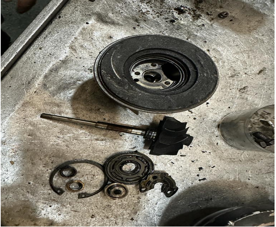
Şekil 3.8. Yabancı cisim hasarına uğrayan turbo
