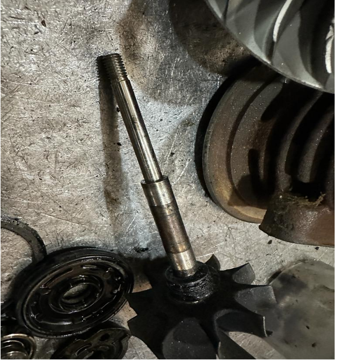
Şekil 3.10. Turbo kanatçık mili eksen kaçıklığı hasarı
