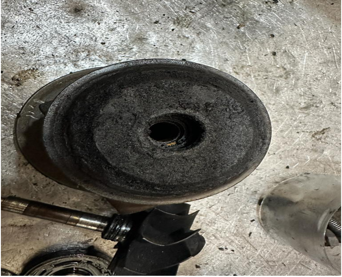
Şekil 3.9. Yanmış yağ kullanımı sonucu oluşan turbo hasarı
