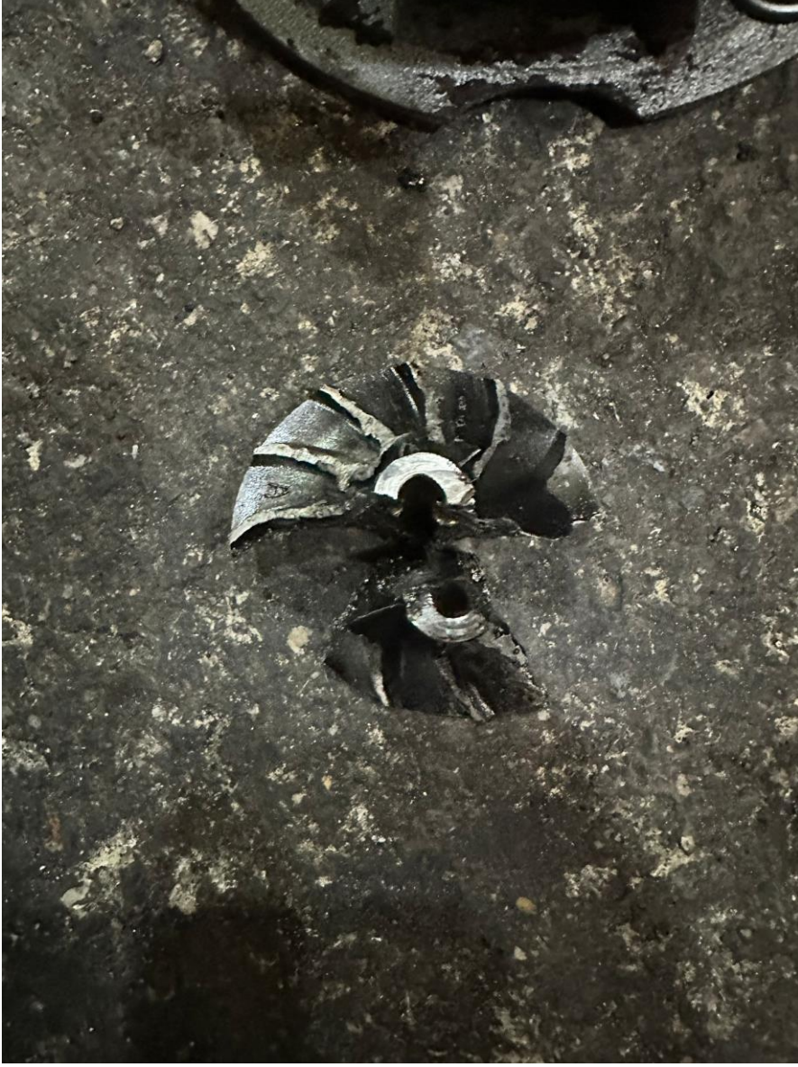
Şekil 3.13. Kırılan turbo kanatçığı
