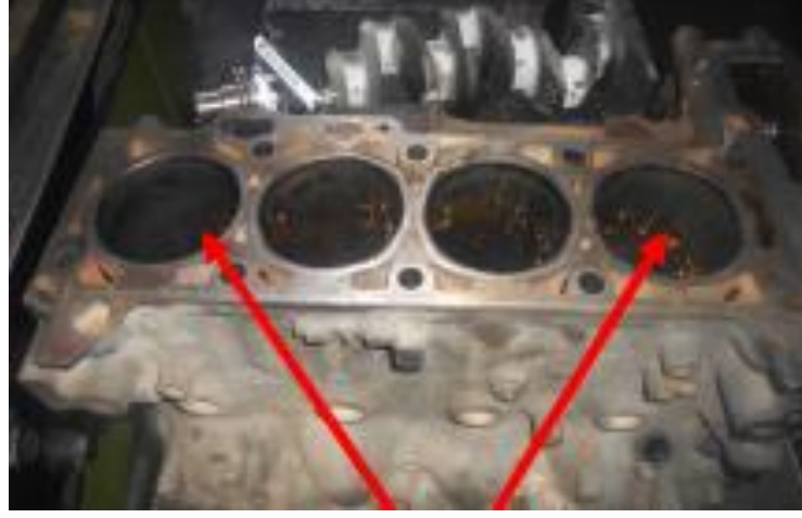
Şekil 3.11. Silindirde meydana gelen aşınma
