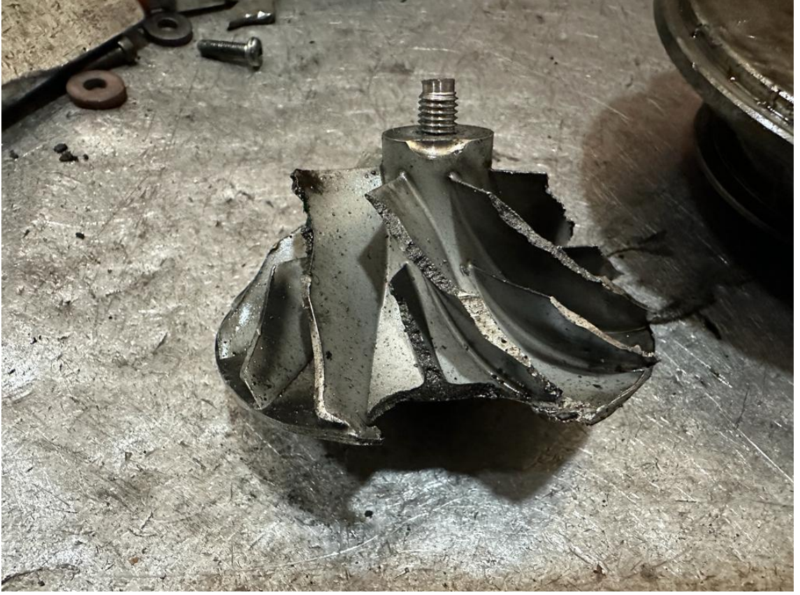
Şekil 3.7. İmal yöntemi esaslı hasar oluşumu
