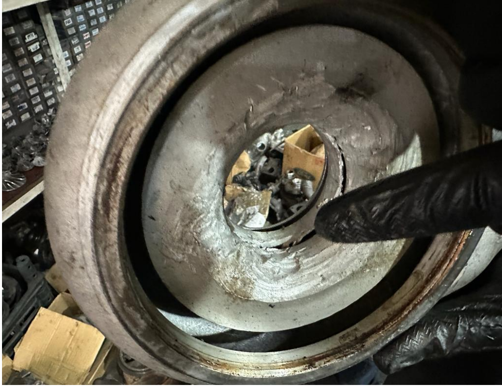
Şekil 3.4. Mekanik hasara uğramış bir turbo motor
