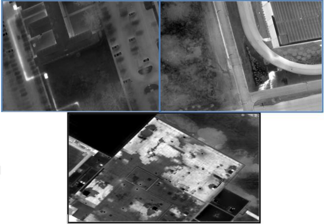
Şekil 3.1. Bir buhar sisteminde ısı kayıpları, buhar borusu çatısının termal görüntüsü, ıslak zeminler ve zemindeki sızıntı [54].
