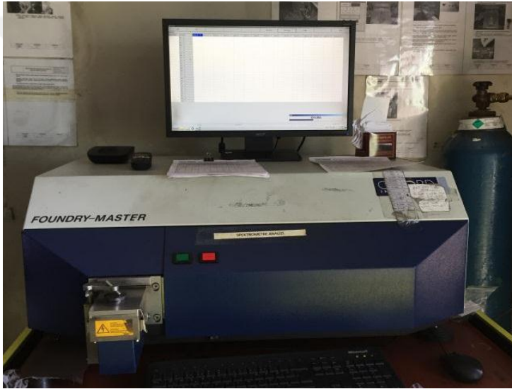
Şekil 7.1. Spektral analiz yöntemiyle kimyasal metal analizlerinin yapıldığı spektrometre analiz cihazı
