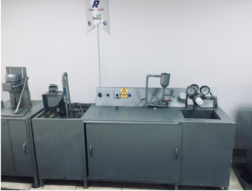
Şekil 2.2.6. Basınç kaybı akış karakteristiği test cihazı(yazar fotoğrafı,2024)
