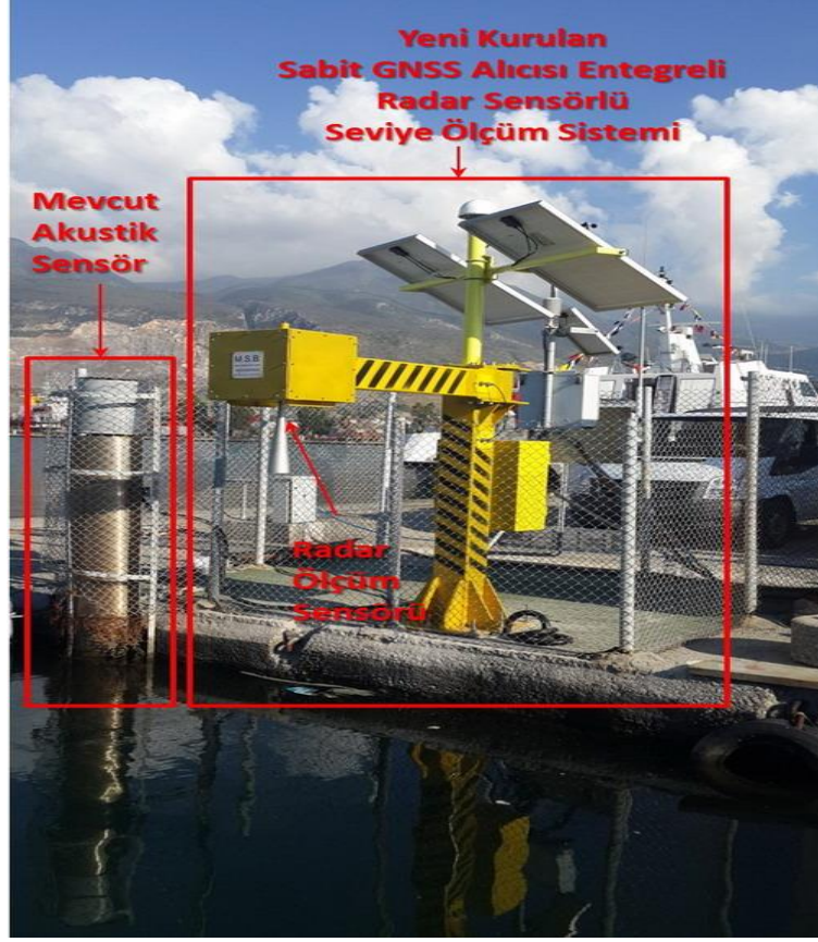
Şekil 4.5: GNSS entegreli radar sensörlü İskenderun mareograf istasyonu.
