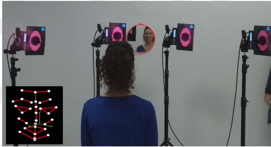
Şekil 3.6. Üç boyutlu optoelektronik hareket analiz sistemi. Sol alt köşede oluşturulan yüz modeli örneği
