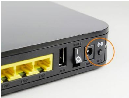
Şekil 4.28. AP üzerindeki PBC düğmesi
