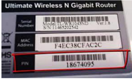
Şekil 4.29. Kablosuz cihazlardaki PIN etiketi
