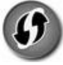
Şekil 4.27. Yönlendirici ve ya AP üzerindeki WPS düğmesi
