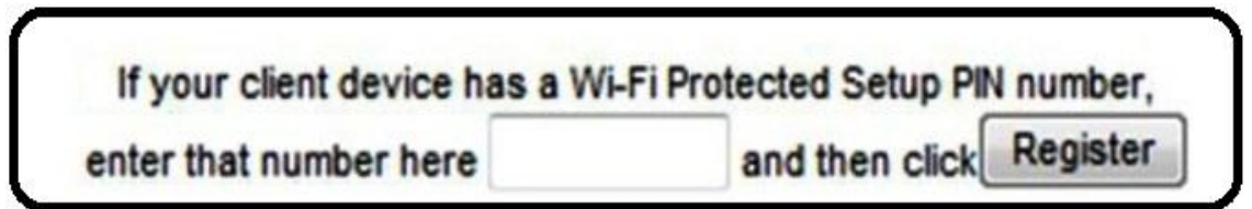
Şekil 4.30. PIN dahili modunun kayıt işlemi
