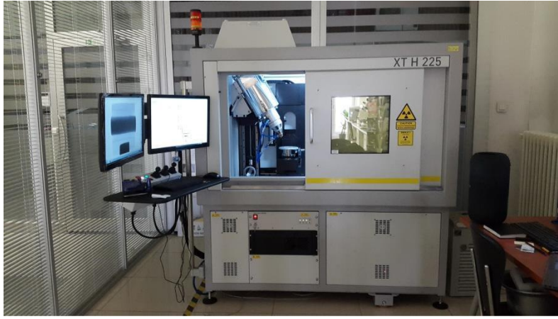
Şekil 5.9. Bilgisayar destekli X-Ray tomografi cihazı
