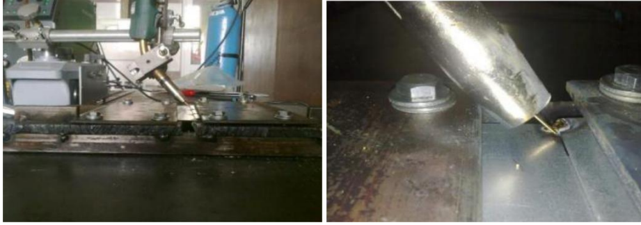
Şekil 5.2. MIG-lehimleme işleminin yapıldığı makine ve sekator
