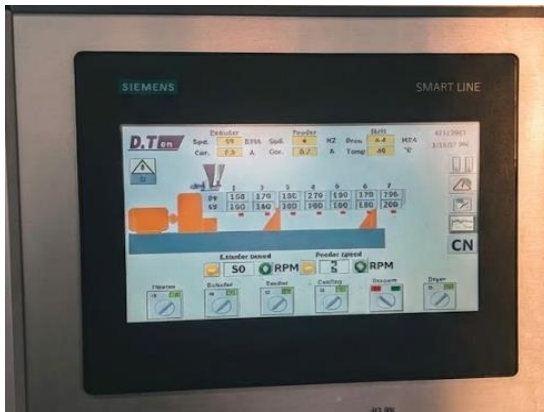
Resim 4.8. Ekstrüder ısı bölgeleri ve ekstrüder makinesi
