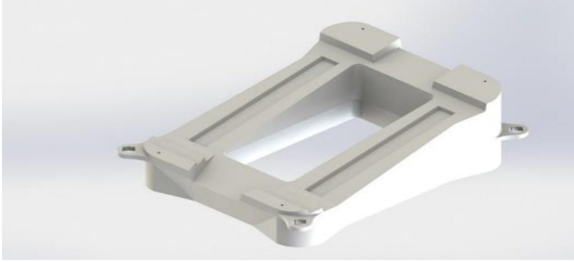
Resim 2.9. Yüzer FV sistemler için tasarlanan panel taşıyıcı duba
