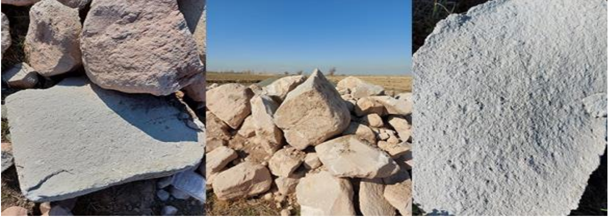
Resim 5.2. Söz konusun evin yapımında kullanılan taşlar
