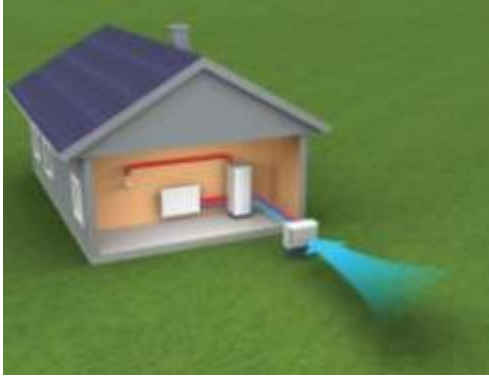
Şekil 4.6. Hava kaynaklı ısı pompasının şematik görüntüsü (Bilen ve Demir, 2021).
