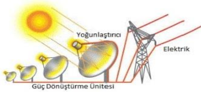
Şekil 3.31. Parabolik çanak sisteminin şematik gösterimi (Üçgül ve ark. 2019).
