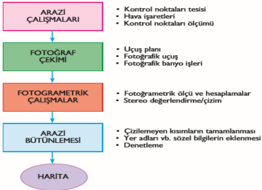
Şekil 2. 8. Klasik fotogrametrik harita üretim süreci
