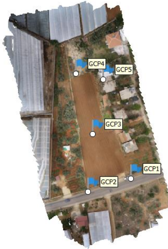
Şekil 3.9. Araziye tesis edilen YKN'lerin çalışma sahasına dağılımı
