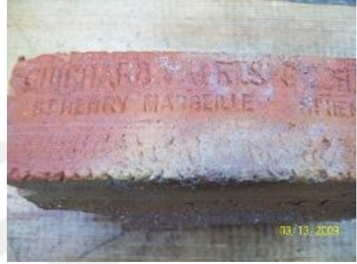
Şekil 4.51: Bursa İpekçilik Mektebi'nde kullanılan ateş tuğlası (YBA arşivi).
