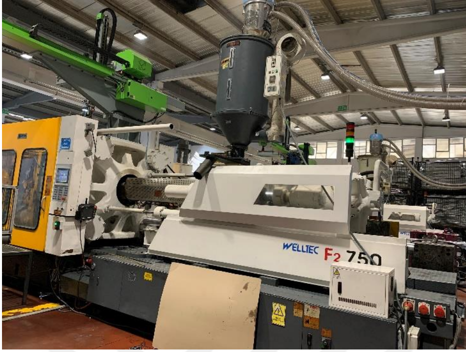
Şekil 2.5 Kullanılan WELLTEC F2 Model Enjeksiyon Makinesi
