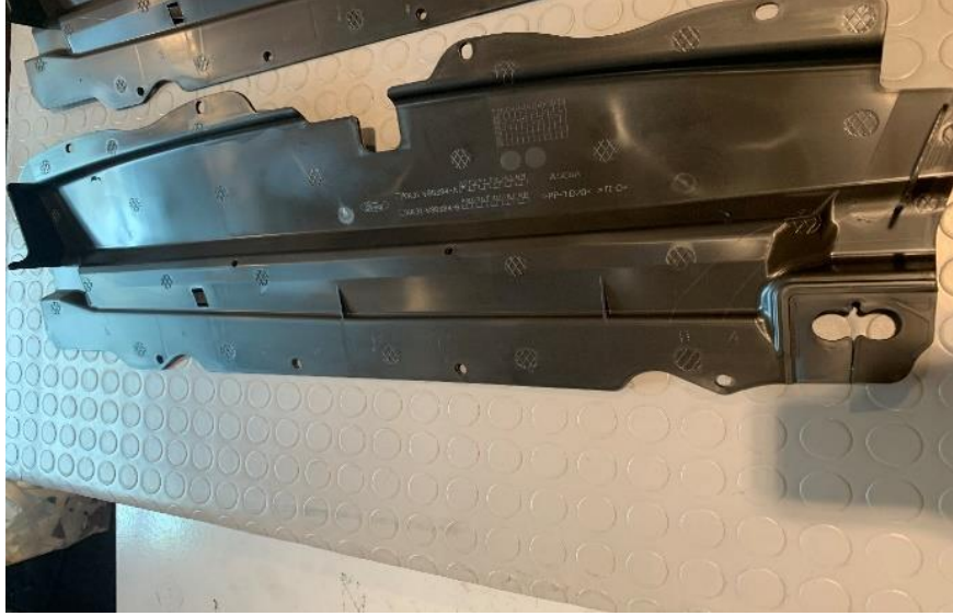
Şekil 2.7 Test numuneleri olarak üretilen iki bileşenli deflektör parçası
