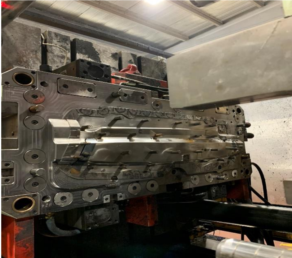
Şekil 2.6 Kullanılan Enjeksiyon Kalıbı
