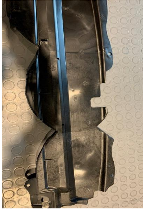
Şekil 2.1 Eksik Enjeksiyon Sonucu Üretilen Plastik Parça
