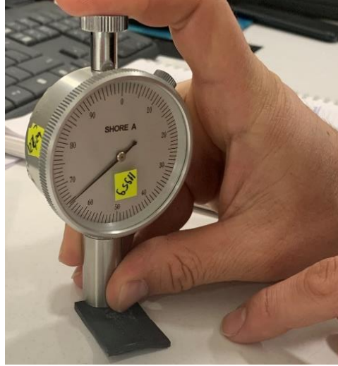
Şekil 2.15 EPDM malzemeye uygulanan sertlik testi
