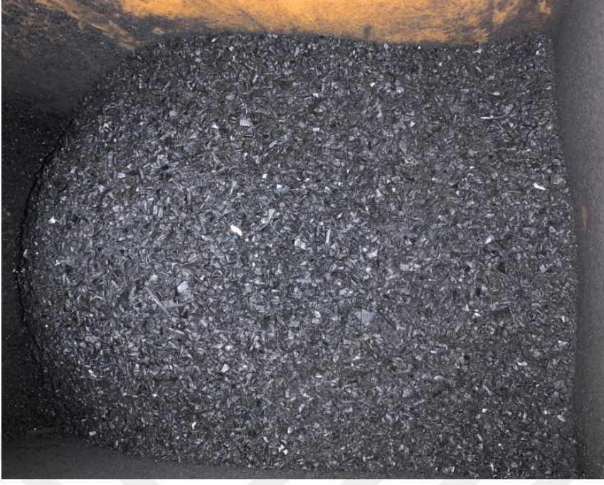
Şekil 2.4 Kırılmış polipropilen parçalar
