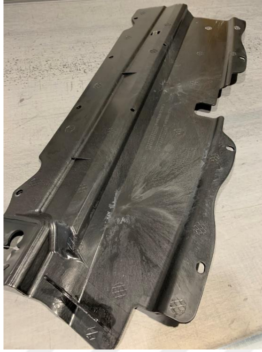
Şekil 2.2 Üretim Başında Deformasyon Hatası
