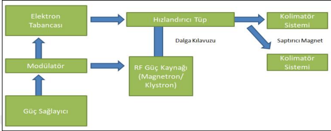
Şekil 2.9. Lineer hızlandırıcının şematik gösterimi
