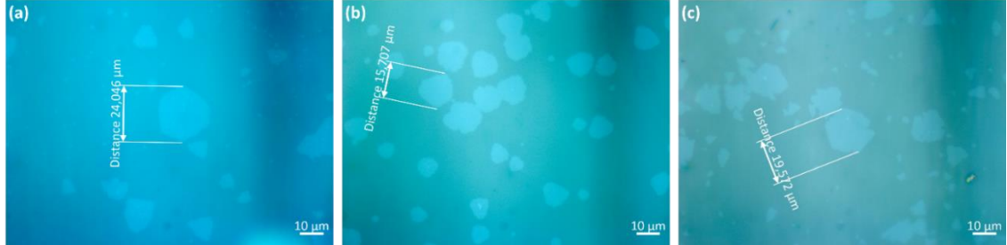
Şekil 25. ReO 3 ve altlık arasındaki mesafe (a) 1,5 cm, (b) 2,5 (c) 0,5 cm olan deney için elde edilen OM görüntüleri (S'ün fırın merkezine uzaklığı 18,5 cm, ReO 3 Miktarı 3 mg, 80/40 sccm Ar, Deney süresi 5 dk, Büyüme sıcaklığı 600°C).
