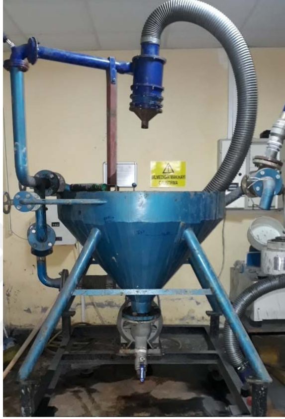
Şekil 2.6 Deneyler kullanılan otojen siklon
