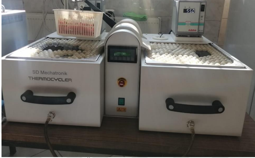
Resim 3.17. Örneklere termal siklus uygulaması
