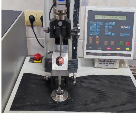
Resim 3.18. Universal Test Cihazı ve örneğin cihaza yerleştirilmesi.
