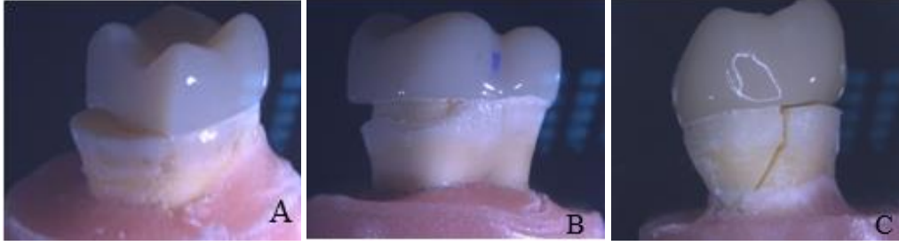
Resim 4.2: Lityum disilikat örneklerin steriomikroskopta izlenen kırılma tipleri.
