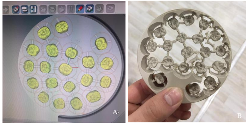
Resim 3.16: A: PEEK blok üzerinde endokron tasarımı. B: PEEK blok üzerinde kazıma sonrası hazırlanan endokron restorasyonların görünümü.
