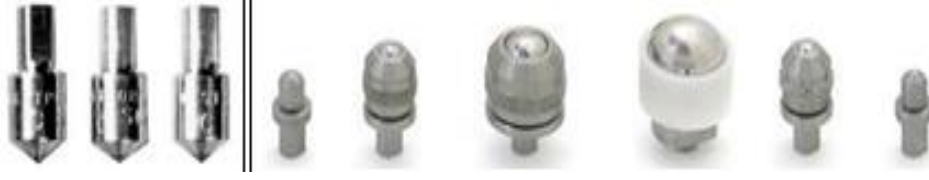
Şekil 6.1. Konik ve bilye uçlu batıcı uç.
