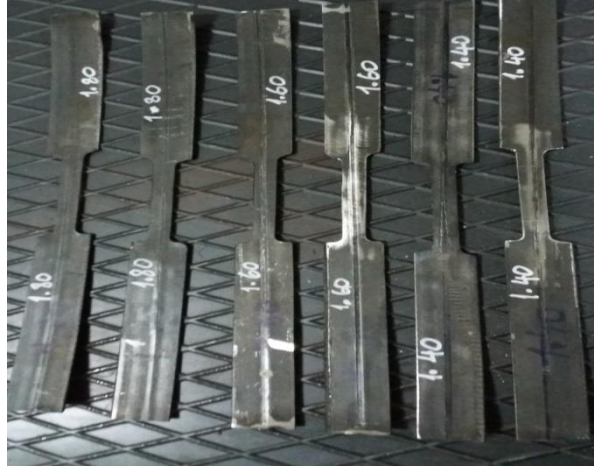
Şekil 7.2. Çekme test numuneleri ( kaynaklı bölge).
