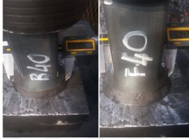
Şekil 7.5. Ağız genişletme testi sonucu 40 m/dak (120kW).
