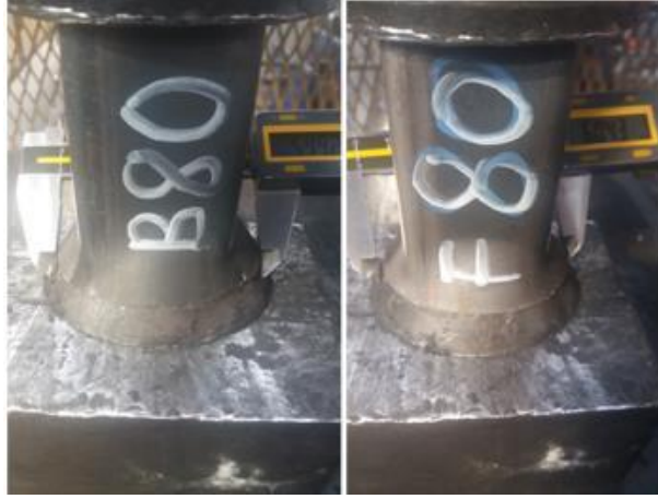
Şekil 7.7. Ağız genişletme testi sonucu 80 m/dak (180kW).
