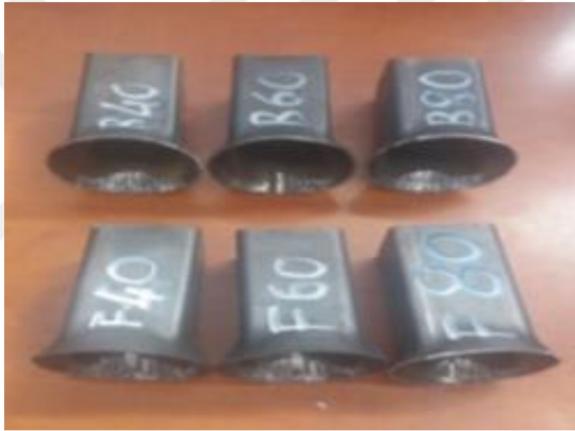
Şekil 7.8. Ağız genişletme testi sonuçları.
