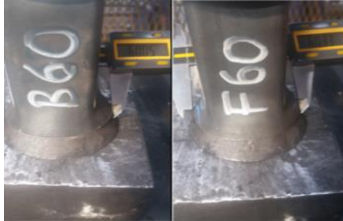
Şekil 7.6. Ağız genişletme testi sonucu 60 m/dak (150kW).
