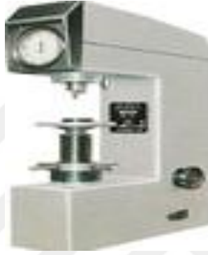
Şekil 6.2. Sertlik ölçüm cihazı.
