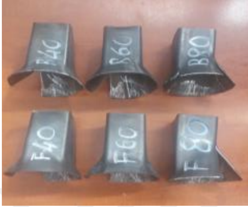
Şekil 7.9. Ağız genişletilip, yırtma testi sonuçları.
