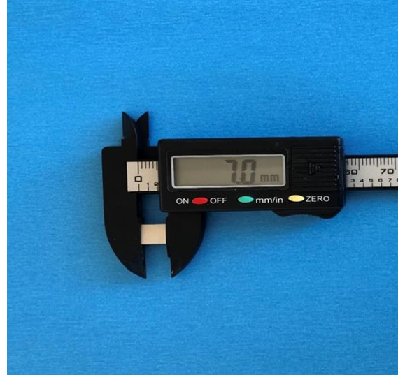
Resim 6. CAD/CAM kullanılarak üretilen PEKK örneğin kenar uzunluğunun kontrol edilme görüntüsü.
