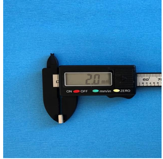
Resim 8. CAD/CAM kullanılarak üretilen PEKK örneğin kalınlığının kontrol edilme görüntüsü.
