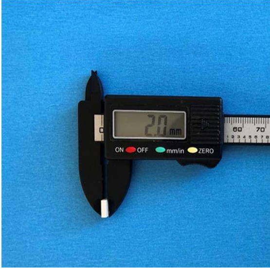
Resim 7. CAD/CAM kullanılarak üretilen PEEK örneğin kalınlığının kontrol edilme görüntüsü.
