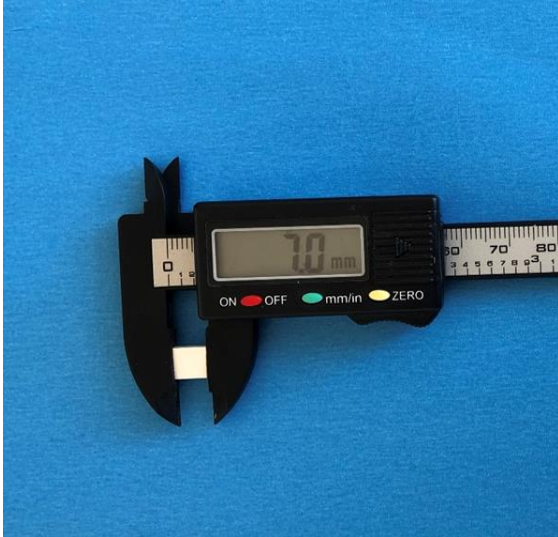
Resim 5. CAD/CAM kullanılarak üretilen PEEK örneğin kenar uzunluğunun kontrol edilme görüntüsü.
