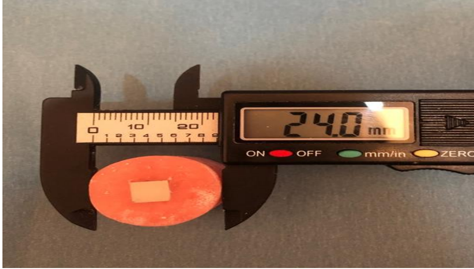
Resim 16. PEEK ve PEKK örneklerin gömüldüğü akrilik çapının kontrol edilme görüntüsü.
