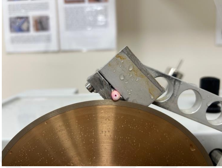
Şekil 3.23. Diş örneğinden elmas diskle kesit alınması
