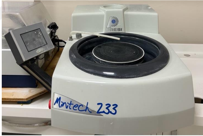
Şekil 3.24. Kesitlerin yüzey düzensizliklerinin giderildiği manuel parlatma cihazı
