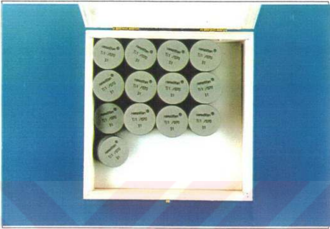
Resim III.9 : Rematitan grade 1 titanyum metali.
