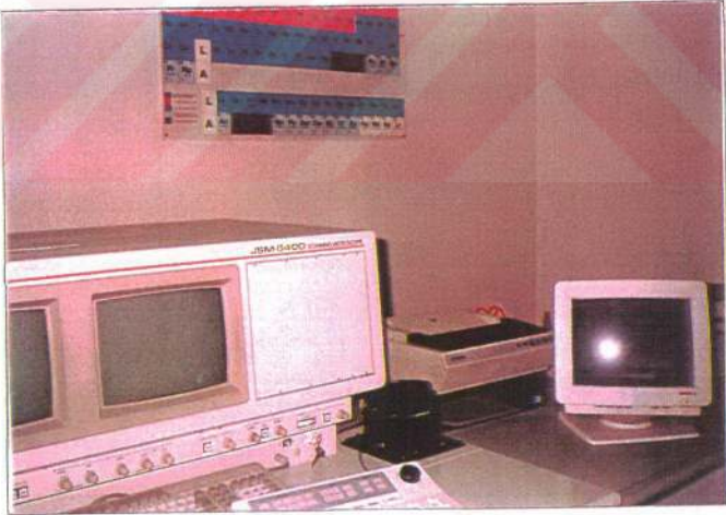
Resim III.16 : SEM'e bağı EDAX analiz ünitesi.
