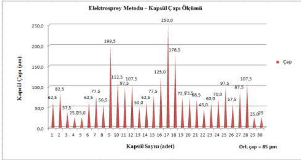
Şekil 5.13. Elektrosprey metodu ile oluşturulan kapsüllerin ışık mikroskopuyla yapılan çapı ölçümü sonuçları.
