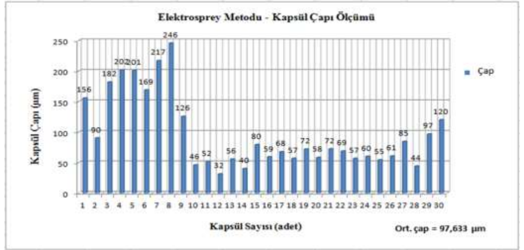
Şekil 5. 15 Elektrosprey metodu ile oluşturulan kapsüllerin inverted mikroskop ile yapılan çapı ölçümü sonuçları.
