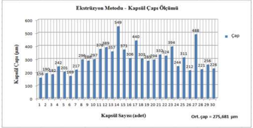
Şekil 5. 14 Ekstrüzyon metodu ile oluşturulan kapsüllerin inverted mikroskop ile yapılan çapı ölçümü sonuçları.
