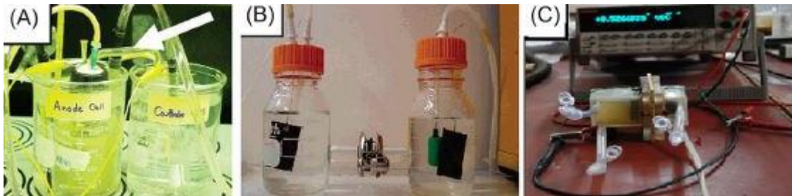
Resim 3.1. Çeşitli mikrobiyal yakıt hücresi tasarımları, (A) tuz köprüsü kullanılan MYH, (B) Reaktif şişeleri ile yapılmış H-tipi MYH, (C) tipik iki odacıklı MYH [6].
