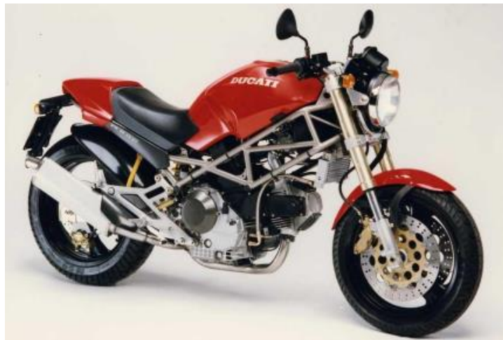
Şekil 8.14. Kafes Çerçevesi Motosiklet Şasi Tasarımı
