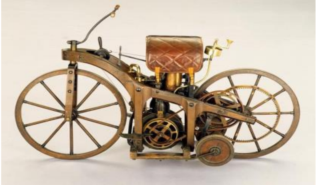
Şekil 8.3. Benzinli İçten Yanmalı Motorla Çalışan İlk Motosiklet
