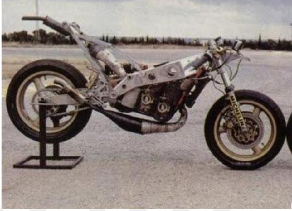
Şekil 8.9. Magnezyum Şasi İle Üretilen Yarış Motosikleti
