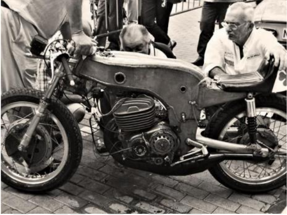
Şekil 8.8. Magnezyum Şasi İle Üretilen Yarış Motosikleti
