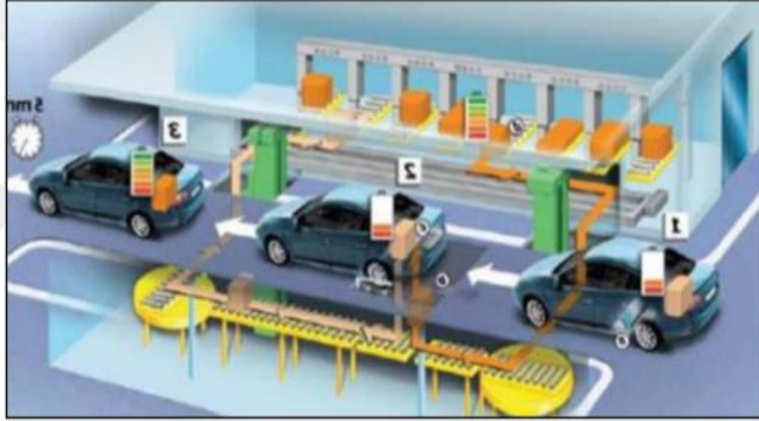
Şekil 5.2. Batarya Değişirme İstasyonu (hedefilo.com)
