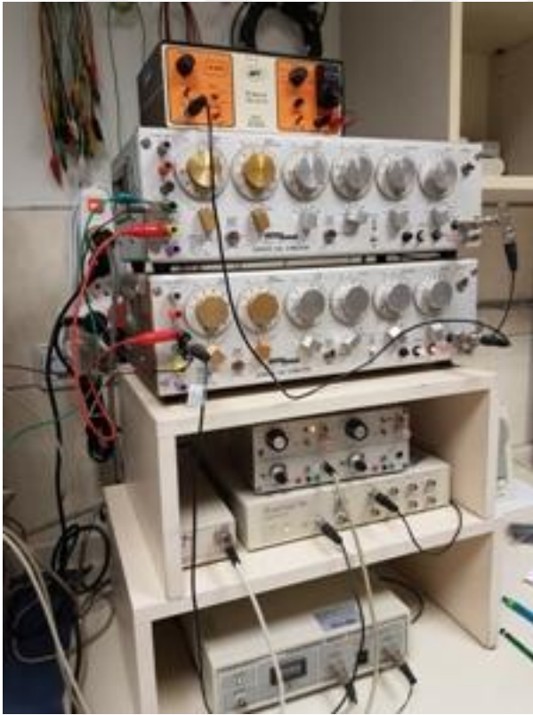
Resim 3.2. Sinyal amplifikasyonu ve veri analizi, EEG amplifikatörü (Kaldıray EX-2C; YSED, Ankara, Turkey) ve veri toplama sistemi ile yapıldı (Powerlab 8/s; AD Instruments, New South Wales, Australia).
