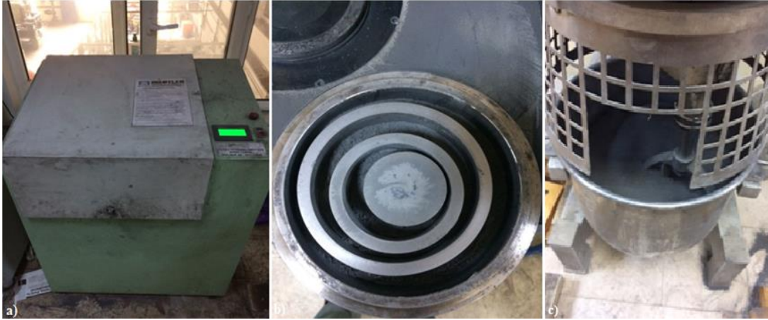
Şekil 3.3. İkincil alüminyum cürufunun öğütülmesi ve karıştırması, a) Öğütme cihazı, b) Halkalar yardımıyla öğütme, c) Karıştırma işlemi.
