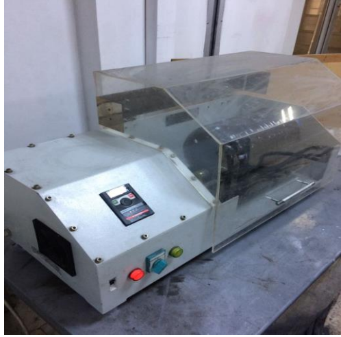
Şekil 3.4. İkincil alüminyum cürufunun yıkanması.
