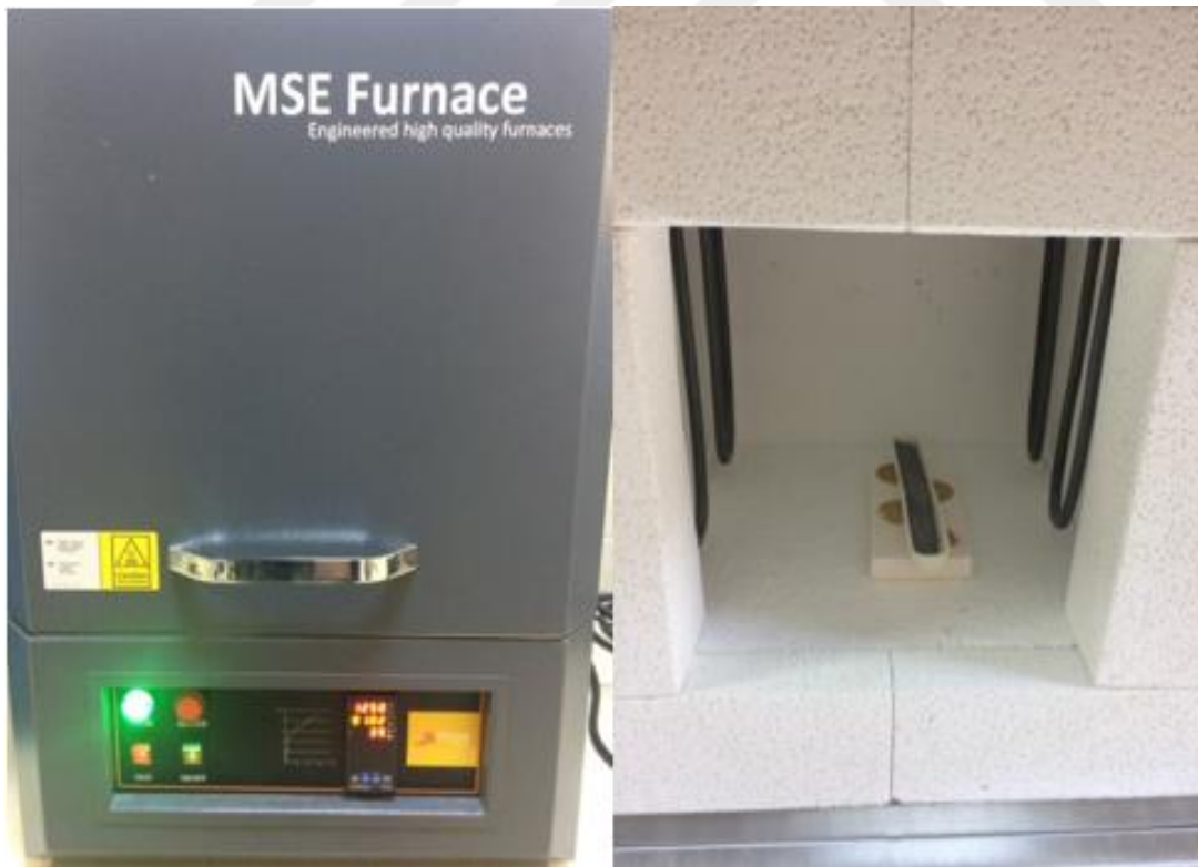
Şekil 3.6. İkincil alüminyum cürufunun sinterlenmesi.
