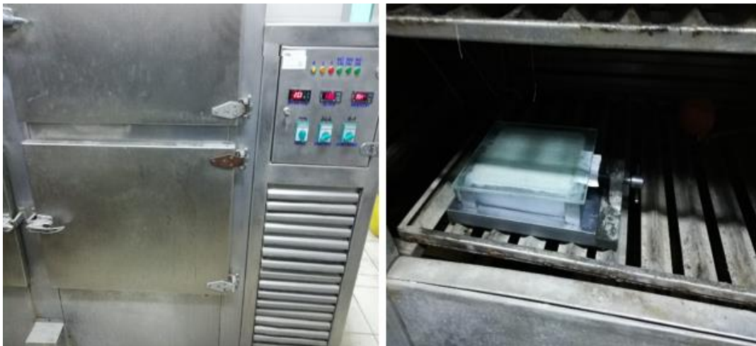
Şekil 3.17. Kür odasında kalıpların bekletilmesi.
