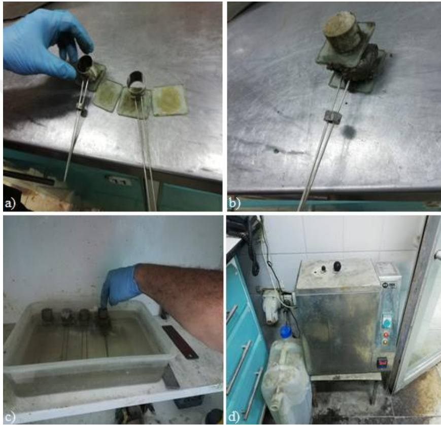
Şekil 3.13. Hacim genleşme deneyi, a) Le chatelier aletinin hazırlanması, b) Çimento hamurunun kalıp içerisine doldurularak kapatılması, c) Su banyosunda bekletme, d) Kaynayan su içerisinde bekletme.
