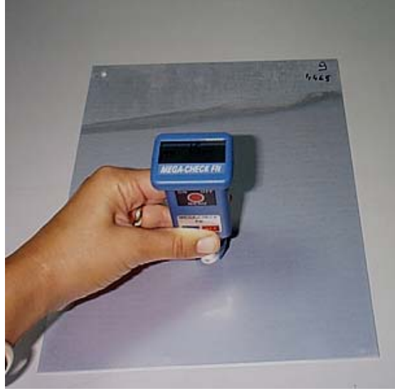
Şekil 5.3 Eddy current ile kalınlık ölçümü
