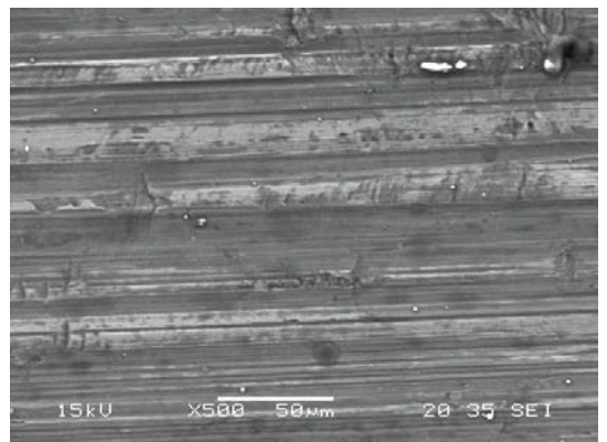
Şekil 4.6 a)TRC b)DC haddelenmiş levha yüzey görünümleri, SEM 35x-100x-250x-500x büyüttmelerde
