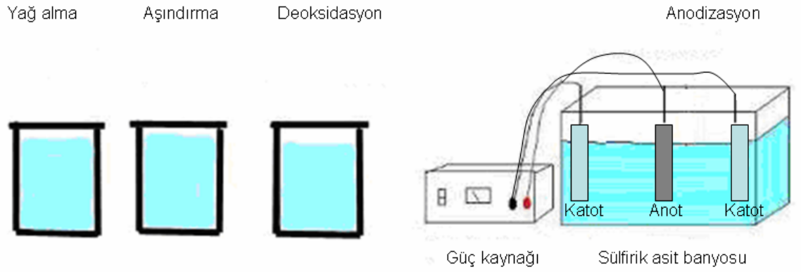
Şekil 4.10 Anodizasyon ünitesi şematik görünümü
