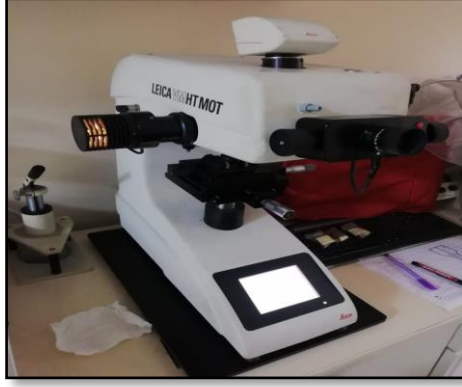
Şekil 5.8. Makro-Mikro Sertlik Cihazları
