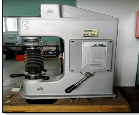
Şekil 5.8. Makro-Mikro Sertlik Cihazları
