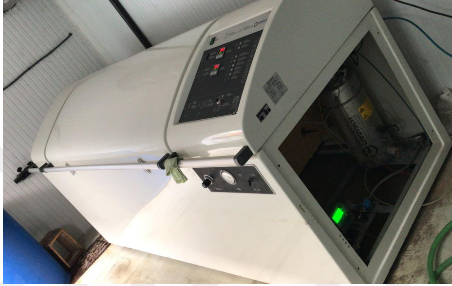
Şekil 3.6. Çalışmada kullanılan tuz testi kabini.
