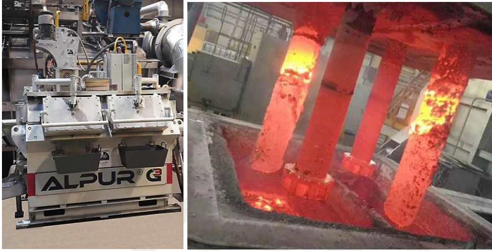
Şekil 2.18. Alpur® gaz giderme cihazı ve sıvı metal ve rotor yüzeyinde biriken hidrojen gazı [44, 45].
