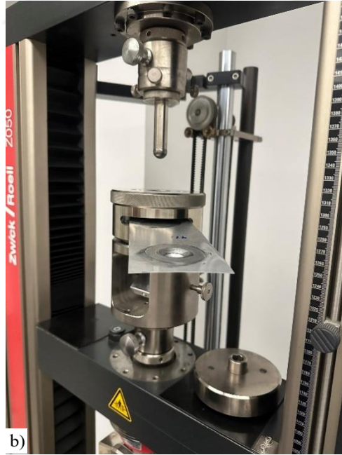
Şekil 3.8. Zwick/Roell test cihazı a) çekme testi b) Erichsen testi.
