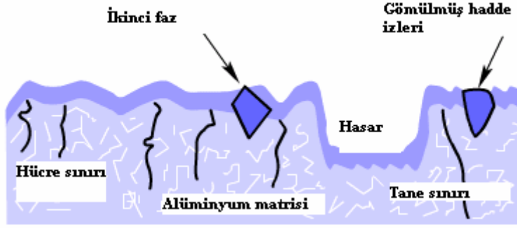
Şekil 5.6 Alüminyumun yüzeyinde bulunan olası hatalar ve kusurlar
