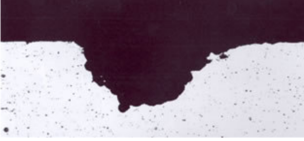
Şekil 5.14 Yüzeyi kaplanmamış alüminyumda görülen çukurcuk korozyonu.[2]
