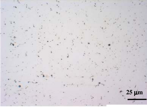
Şekil 8.14 T4 ısıtıl işlemi sonrası TRC döküm tekniği ile üretilmiş malzemede intermetalik partikül dağılımı ve geometrisi.
