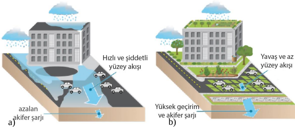
Şekil 2.8: Kentsel alanlarda geçirimsiz a) ve geçirgen b) yüzeyler arasındaki karşılaştırma
