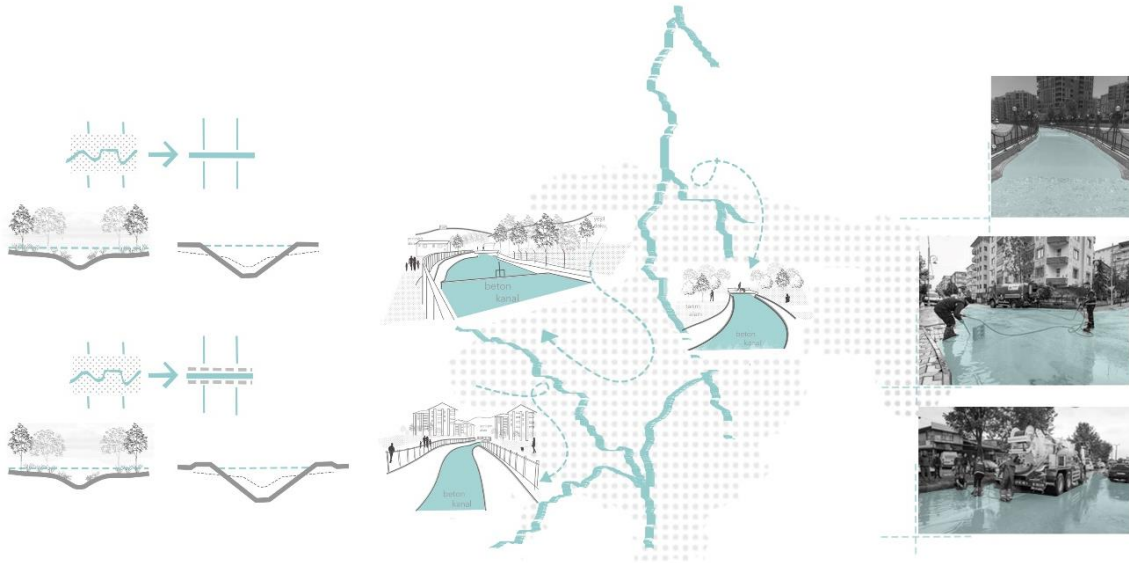
Şekil 5.1: Suyun kent içerisinde betonarme kanallar ile iletilmesi
