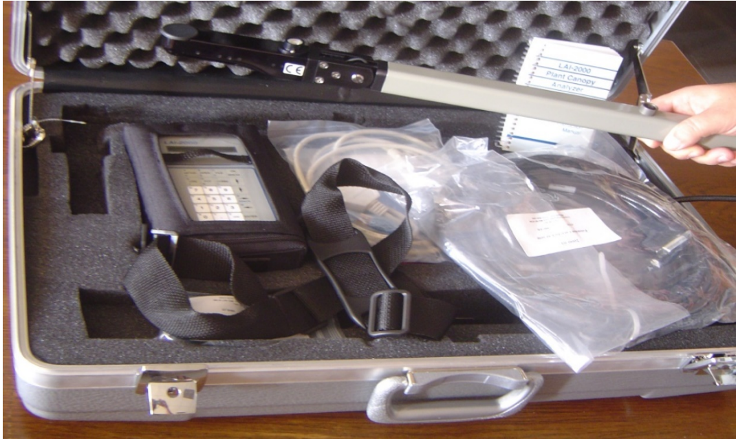
Şekil 2.3: Yaprak alan indeksi (LAI) ölçer.
