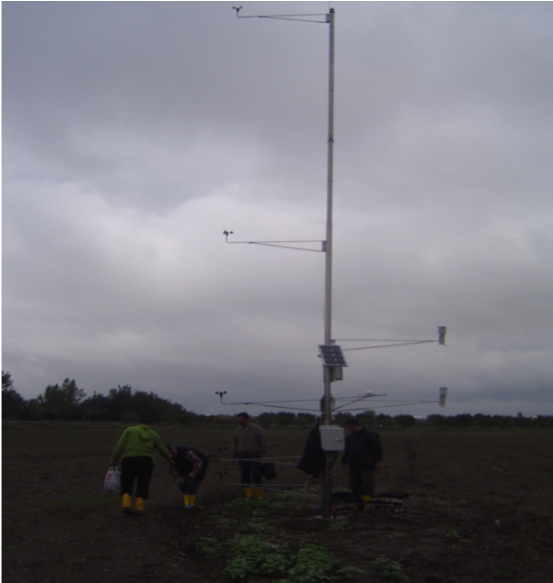
Şekil 2.2: Deneme alanına kurulan meteoroloji istasyonu.
