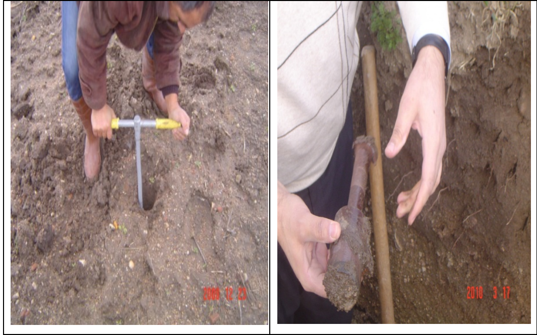
Şekil 2.6: Toprak profili açılması ve örnek alınması.
