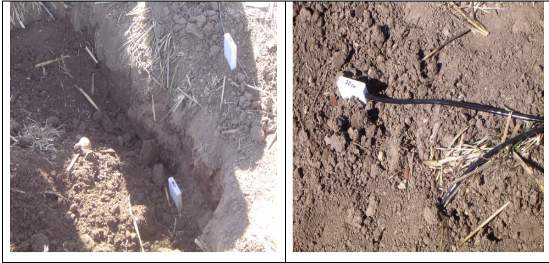
Şekil 2.5: Toprak su içeriği ve sıcaklığı ölçen sensörlerin yerleştirilmesi.
