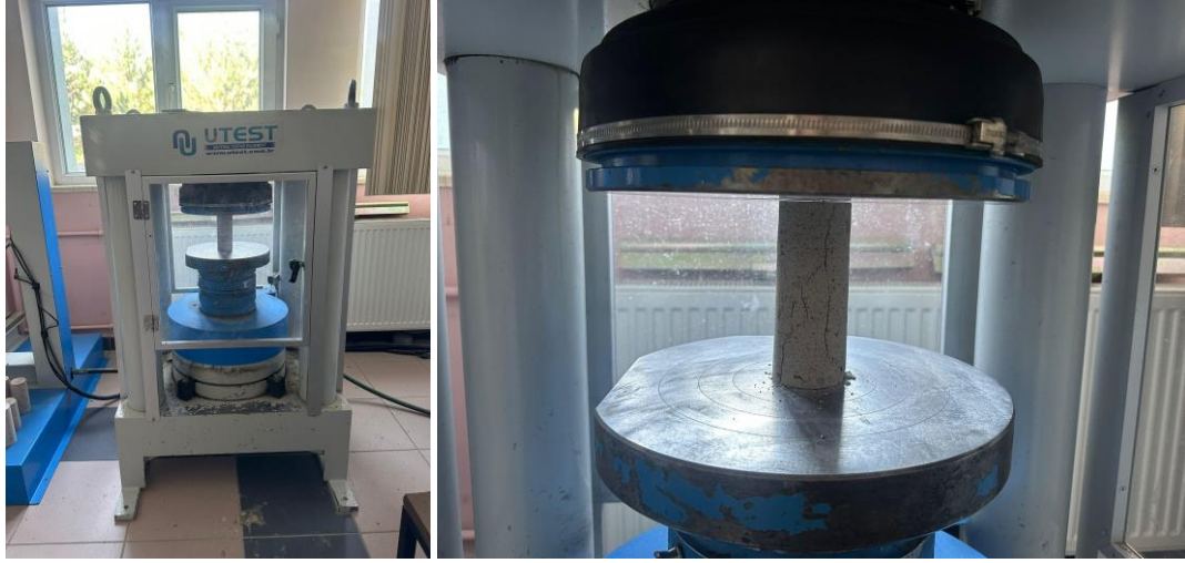
Şekil 4.6. Tek eksenli basınç dayanımı testi (a), kırılan numune görüntüsü (b)
