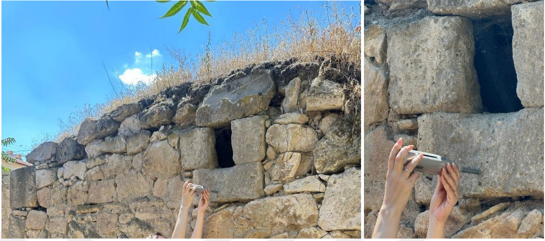
Şekil 4.3. Schmidt çekici ölçümü
