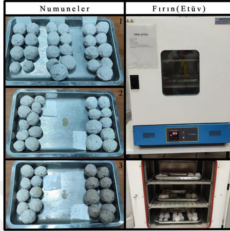
Şekil 4.8. Islak kararlılık deneyi için numune hazırlanması ve etüv işlemi
