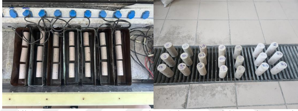
Şekil 4.7. Donma-çözülme test aşamaları; a) donma süreci, b) çözülme süreci
