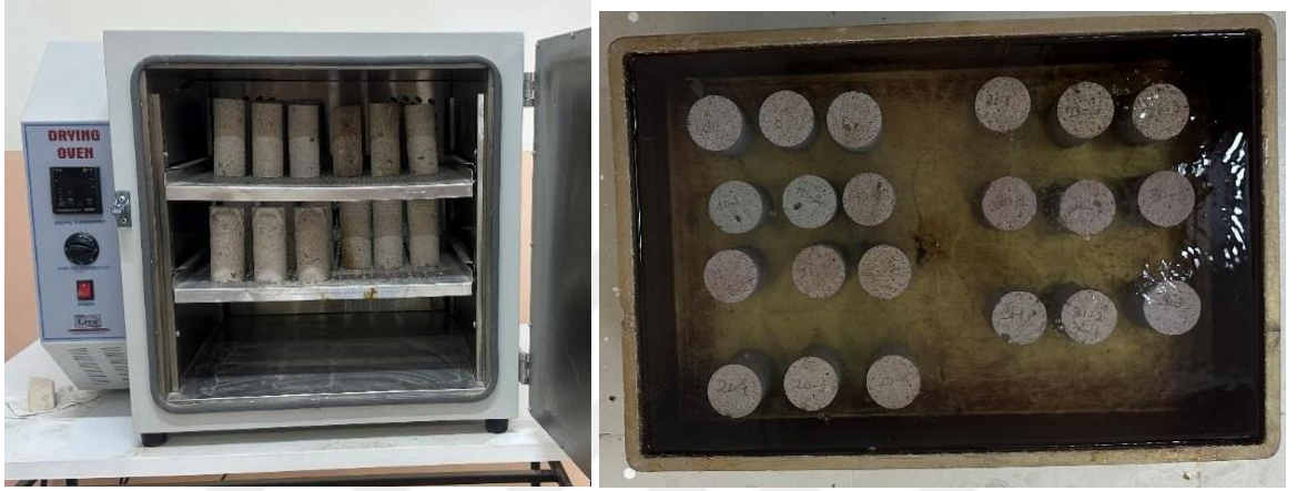
Şekil 4.5. Numunelerin etüvde kurutulma (a) ve su içerisinde bırakılma işlemleri (b)
