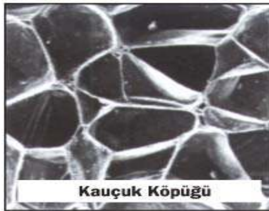
Şekil 3.2. Elastomerik kauçuk köpüğünün mikro yapısı
