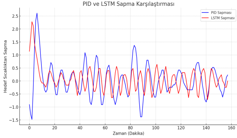
Şekil 4-9. 20°C PID ve LSTM Sıcaklık Sapma Karşılaştırması
