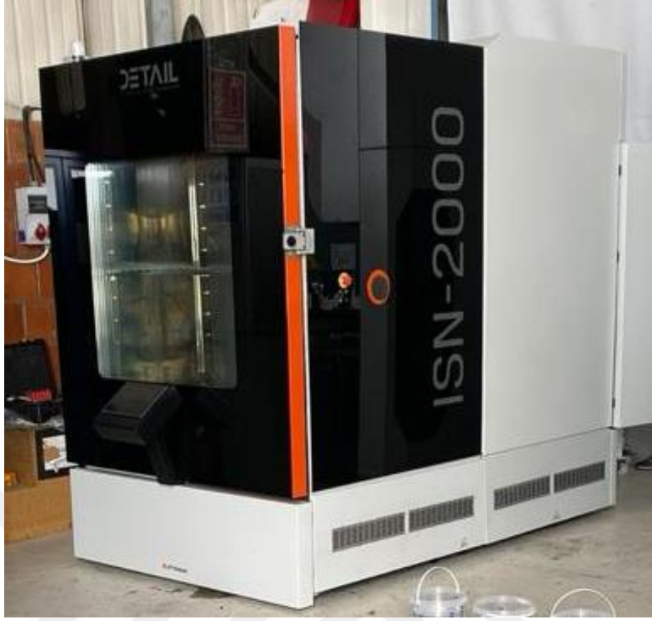
Fotoğraf 4-1. Kullanılan İklimlendirme Test Kabini (Detail Test Kabinleri, 2023)
