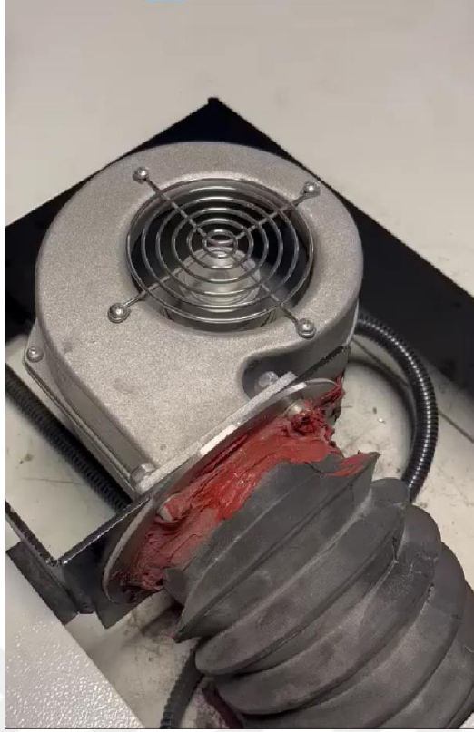
Fotoğraf 4-4. Isıl Yük Taklidi İçin Kabine Hava Üfleyen Baca Mekanizması
