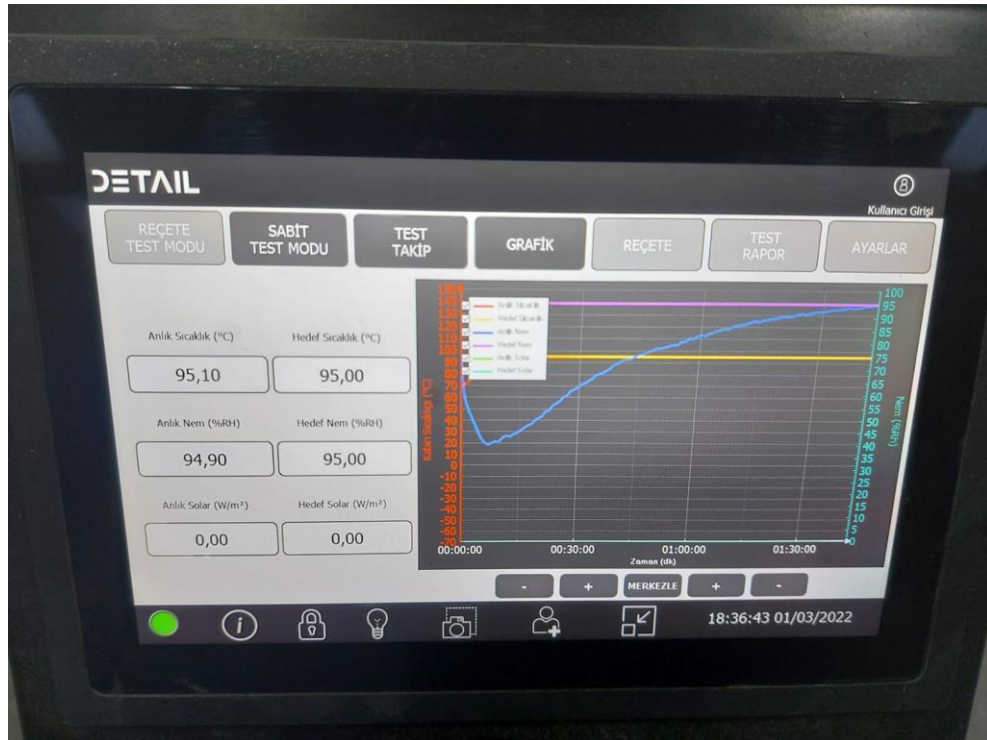
Fotoğraf 4-2. İklimlendirme Test Kabini PC ve Kontrol Arayüzü
