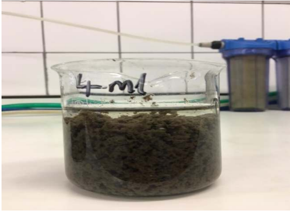
Şekil 2.5. Katyonik Polielektrolit ile şartlandırılmış aktif çamur (MASKİ, 2020)
