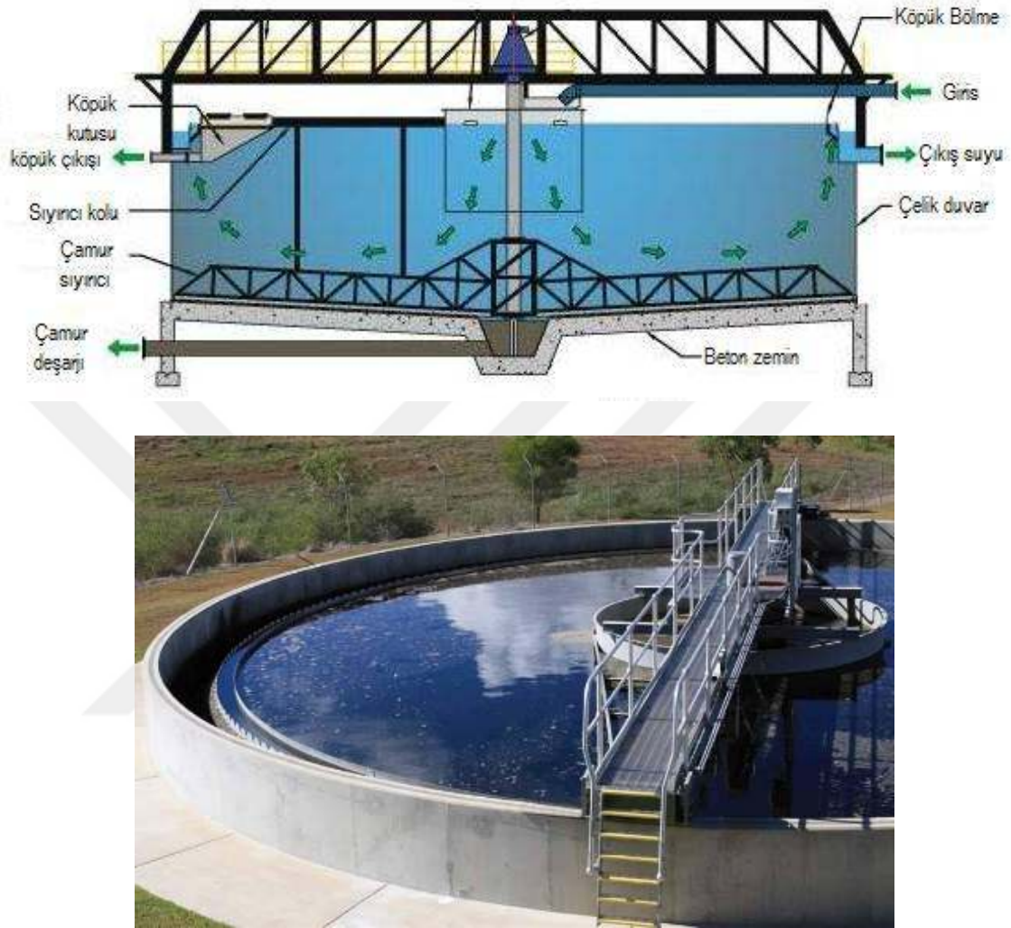
Şekil 2.2. Tipik bir graviteli yoğunlaştırıcının çalışma prensibi (Monroe Environmental Corporation, Monroe, MI, 2020)
