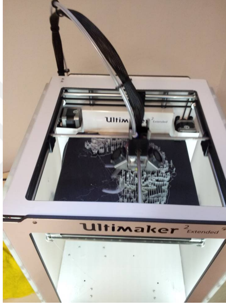
Şekil 4. 3 boyutlu yazıcının omurga modelini katmanlar halinde basımı
