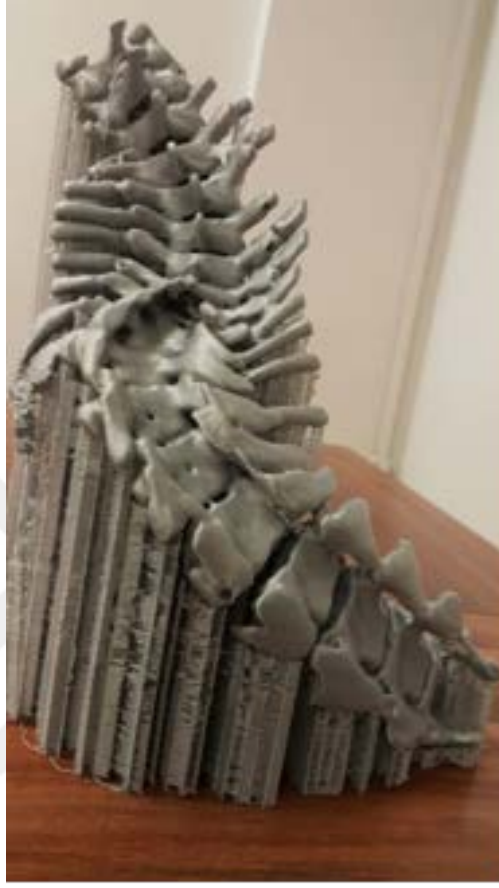
Şekil 6. 3 boyutlu yazıcının basım tezgahından çıkarılan omurga modeli (henüz taşıyıcı kolonlar temizlenmemiş halde)
