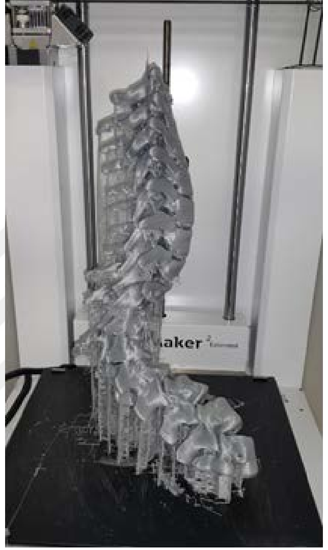
Şekil 5. Omurga modelinin basım sonundaki önden ve yandan görünüşü
