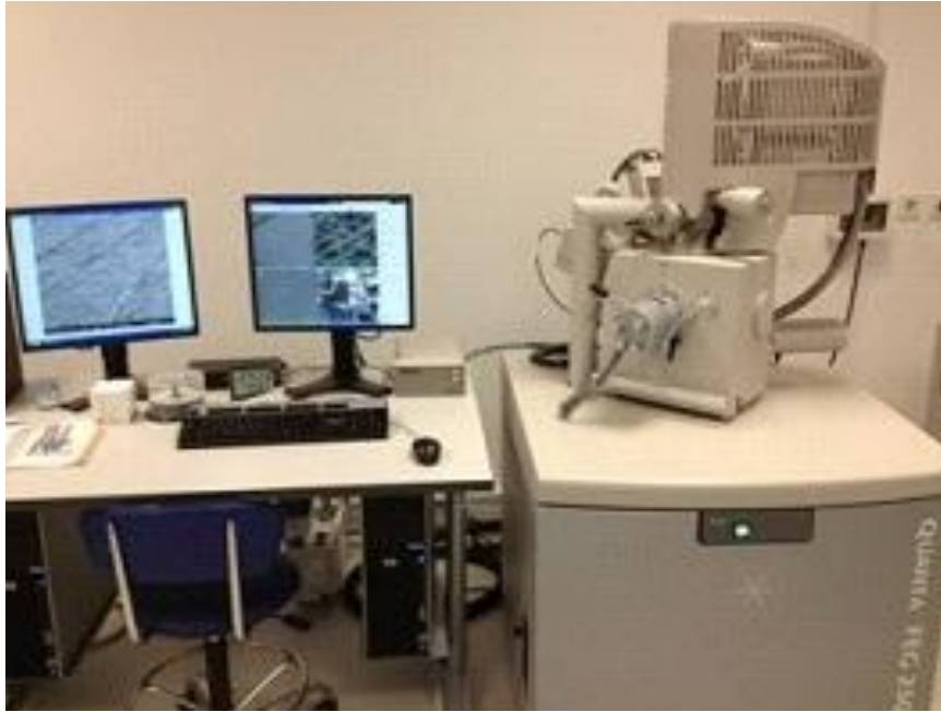
Figure 3.8: SEM set up (FEI Quanta FEG 200).
