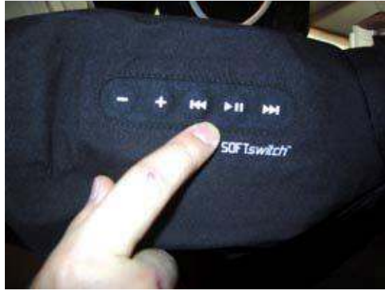
Şekil 2.34 Ceket koluna entegre edilmiş Softswitch™ (SOFTswitch Ltd, 2006)
