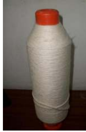
Şekil 3.1 Ne 0,60 ve Ne 0,85 pamuk fitili örneği
