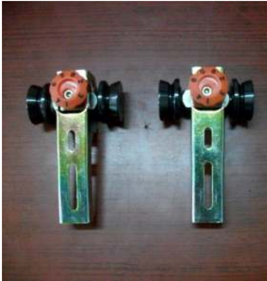
Şekil 3.6 Ring iplik makinesinde kullanılan lycra aparatının görünümleri
