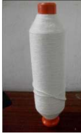
Şekil 3.1 Ne 0,60 ve Ne 0,85 pamuk fitili örneği
