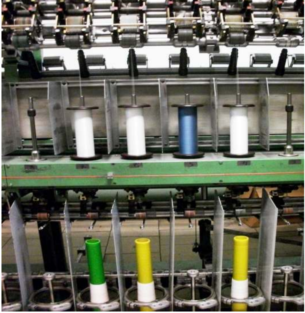
Şekil 3.10 Metal tellerin fantezi iplik makinesi üzerine yerleşimi
