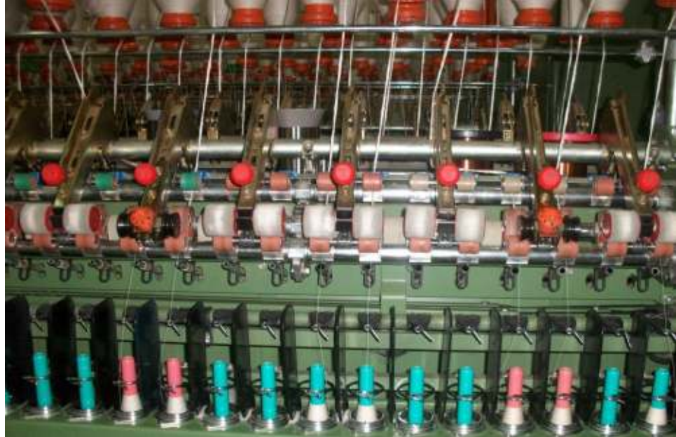
Şekil 3.8 Metal tellerin ring iplik makinesi üzerine yerleşimi
