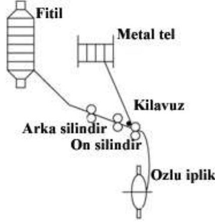
Şekil 2.21 Modifiye edilmiş ring iplik makinasında, fitil ve metal telin özlü iplik eğirme sistemi mekanizmasındaki işlevini gösteren diyagram (Lou, 2005)
