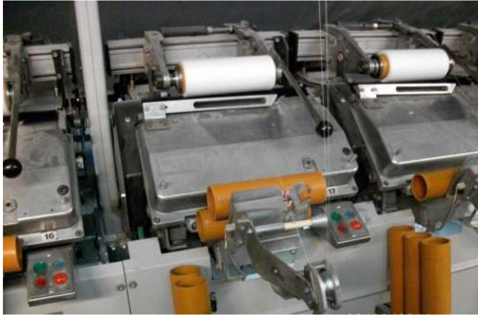
Şekil 3.13 Metal tellerin katlama iplik makinesi üzerindeki yerleşimi
