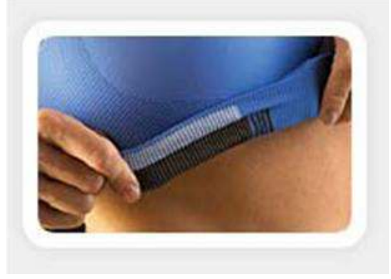
Şekil 2.28 Kalp ritmini ölçebilen tişört ve kalp atış hızını ölçebilen ve monitöre aktarabilen sütyen (Textronics, 2006)
