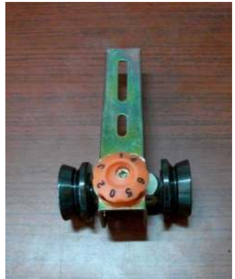
Şekil 3.6 Ring iplik makinesinde kullanılan lycra aparatının görünümleri
