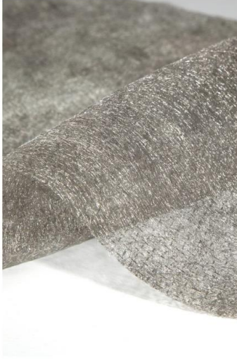
Şekil 1.5 Bakır Tel İçeren İletken Dokuma Kumaş [11]
