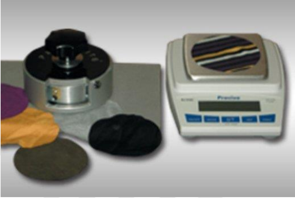
Şekil 2.24 Gramaj Tester ve Hassas Terazî [50]
