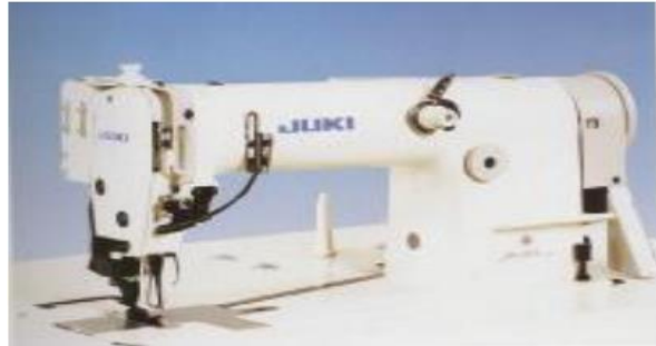
Şekil 2.26 Zincir Dikiş Makinelerine Örnek [51]
