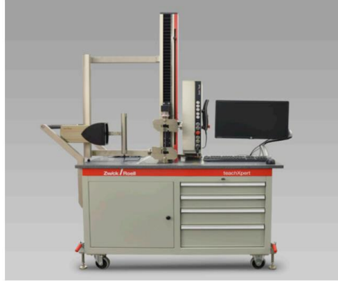
Şekil 2.4. Zwick Roel Esnetme Cihazı [41]
