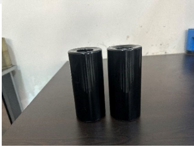
Şekil 4.10. RTFOT sonrası kütle kaybını bulmak için ayrılan iki adet numune şişesi
