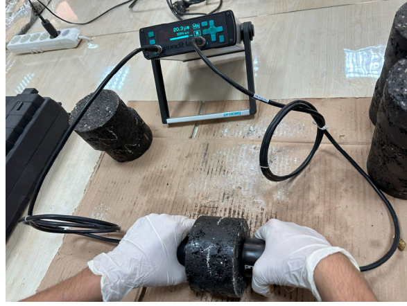
Şekil 4.18. Marshall numunelerine UPV testi yapılması
