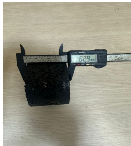
Şekil 4.17. Briketin yüksekliğinin ölçülmesi
